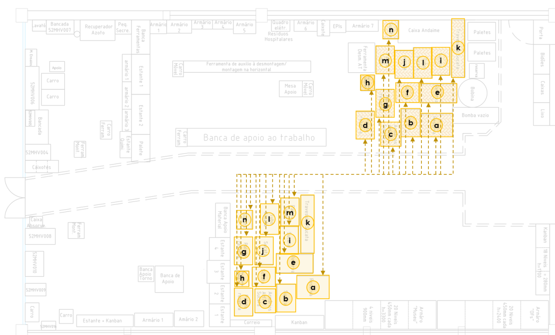
Figura 72 – Deslocações dos operados ao desobstruir a área de trabalho
