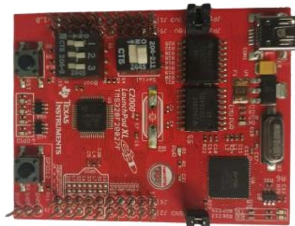
Figura 5.4 - placa de desenvolvimento LAUNCHXL-F8027F C200.
