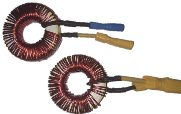
Figura 5.2 - Bobinas utilizadas no conversor *boost interleaved*.
