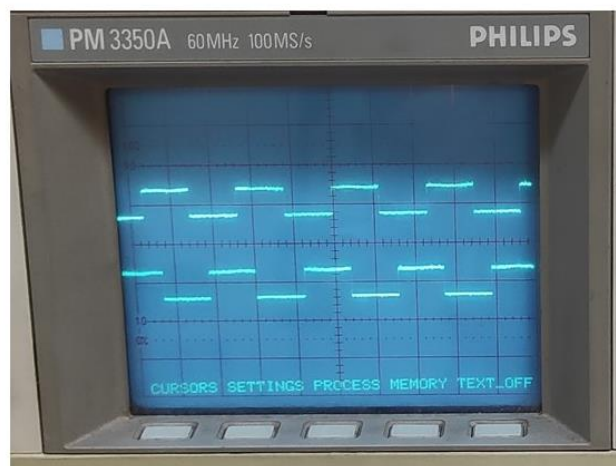
Figura 58 - Sinais obtidos entre as fases S e R do sensor Hall do motor da árvore
