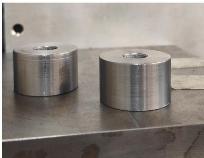
Figura 77 - Espaçadores desenvolvidos para o conjunto preso ao pistão do cilindro pneumático
