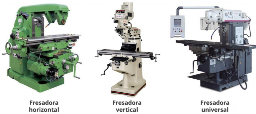
Figura 11 – Tipos de fresadora quanto à orientação da ferramenta (Retirado de: [21])
