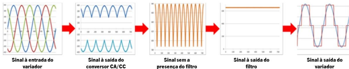
Figura 85 - Diferentes sinais obtidos ao longo da passagem da corrente no variador (Retirado de: [65])
