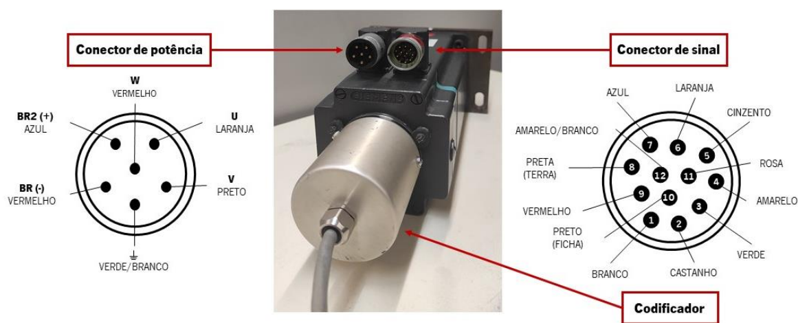
Figura 52 - Correspondência entre os pinos das unidades do servomotor do eixo Y e os fios da ficha
