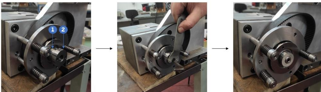
Figura 103 - Fixação do cilindro e batente no fuso
