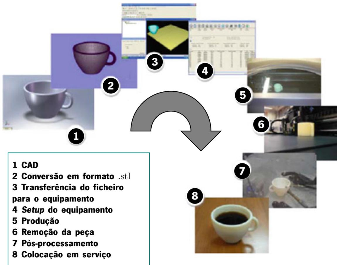
Figura 14: Etapas genéricas entre o CAD e a peça final (adaptado de I. Gibson et al. (2015a)).
