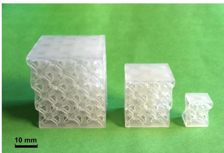
Figura 51: Provetes cúbicos com fração volúmica 30 % com três arranjos distintos de VRU: (esq.) provete com configuração de  $3 \times 3 \times 3$  (27) VRU, (cen.) provete com configuração de  $2 \times 2 \times 2$  (8) VRU e (dir.) provete com configuração de  $1 \times 1 \times 1$  (1) VRU.
