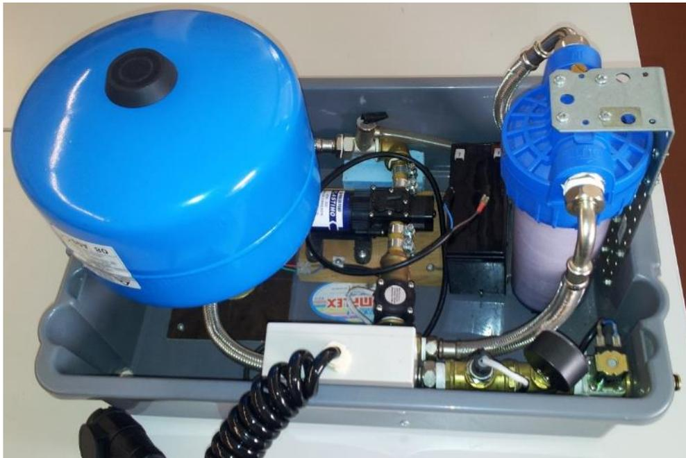
Figura 20. Unidade de preparação da água
