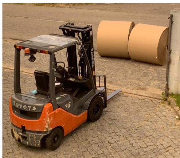
Figura 15 - Exemplo de um desequilíbrio de bobines transportados por um empilhador
