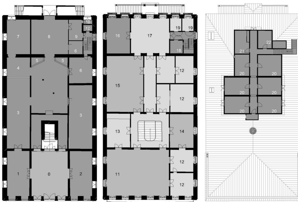
Figura 12 - Planta Piso 0 - Piso 1, e Piso 2, da Casa JFS<sup>10</sup>
