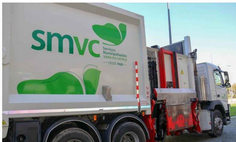
Figura 34 - Viatura de carga lateral para recolha seletiva dos biorresíduos alimentares domésticos (Alto Minho TV, 2020)
