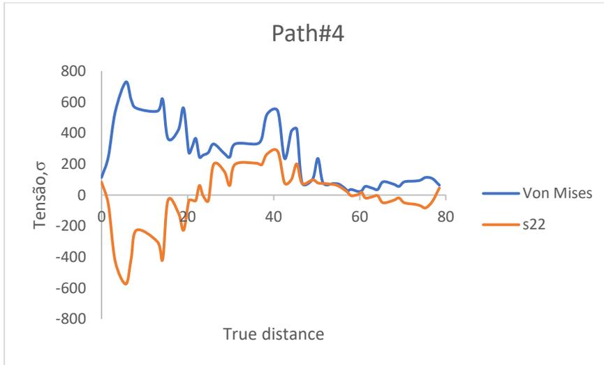
Figura 69 - Gráfico Tensão segundo Von Mises e Tensão normal, ao longo do path#4
