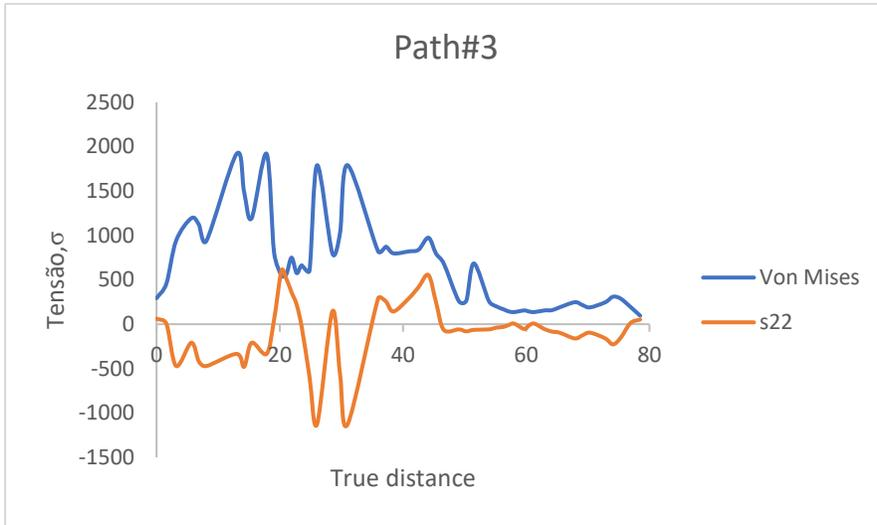
Figura 68 - Gráfico Tensão segundo Von Mises e Tensão normal, ao longo do path#3
