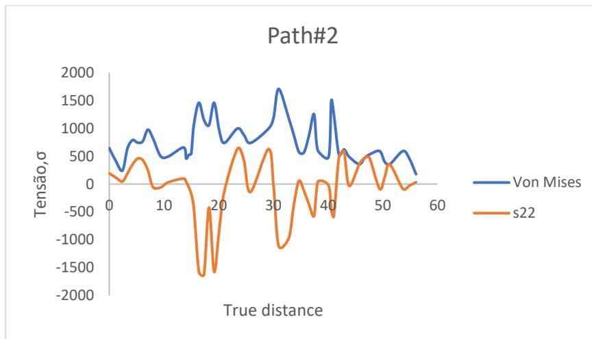
Figura 67 - Gráfico Tensão segundo Von Mises e Tensão normal, ao longo do path#2
