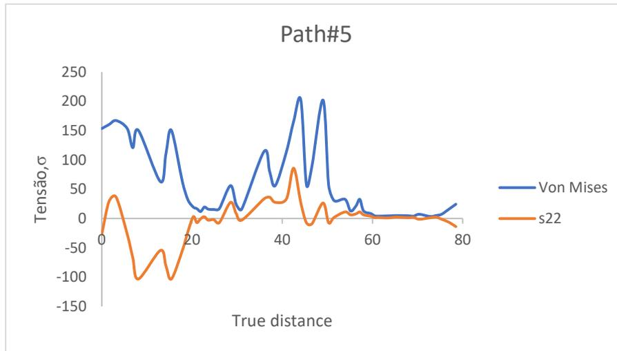
Figura 70 - Gráfico Tensão segundo Von Mises e Tensão normal, ao longo do path#5
