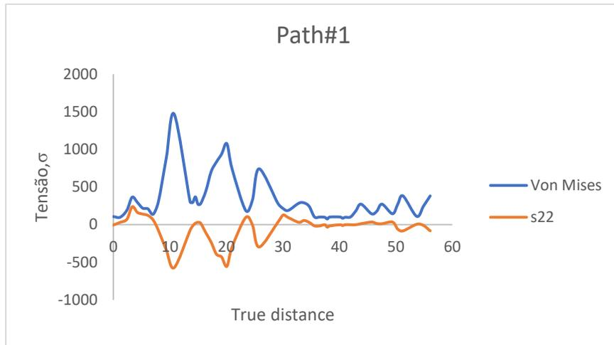
Figura 66 - Gráfico Tensão segundo Von Mises e Tensão normal, ao longo do path#1.
