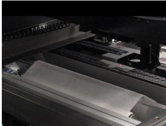
Figura 49 – Sistema de Limpeza da máquina Ekra Serie 5000.
