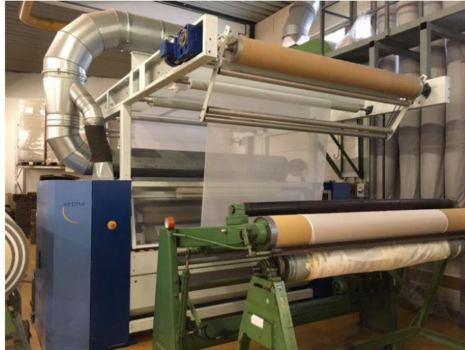
Figura 30 - Máquina de laminar utilizada na instalação
