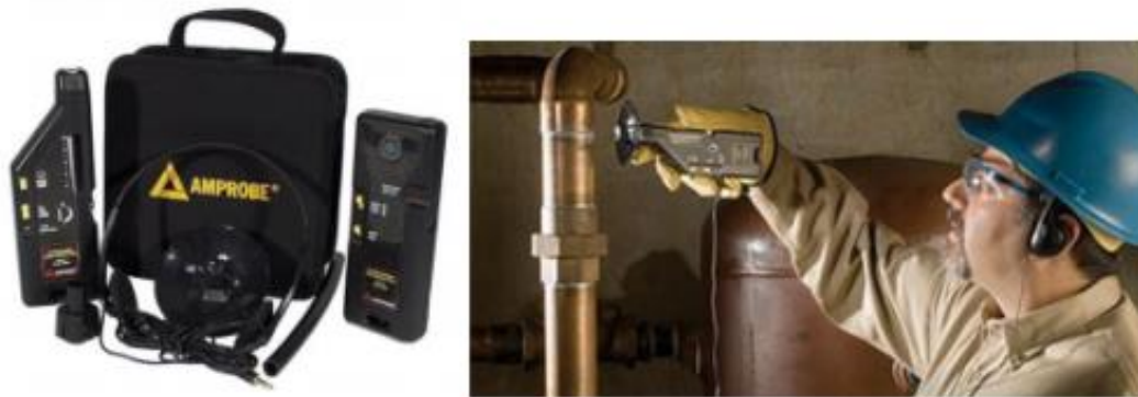
Figura 105 - Exemplo de equipamento de ultrassons utilizado na deteção de fugas de ar comprimido
