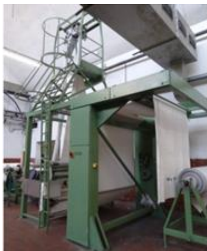
Figura 28 - Máquina de abrir instalada na tinturaria antiga
