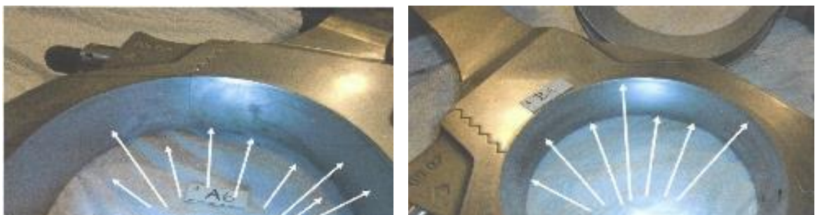
Figura 3-148 - Sinais de fretting nas cabeças das bielas, setas a branco
