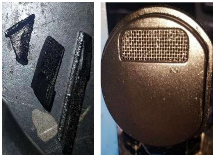
Figura 3-62 - Resíduos do tensor que se partiu e colmataram o filtro de aspiração.
