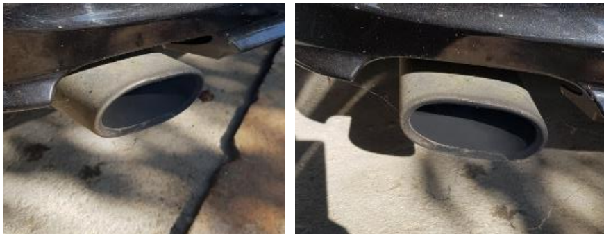
Figura 3-169 - Escape do veículo com sinais de fumo.
