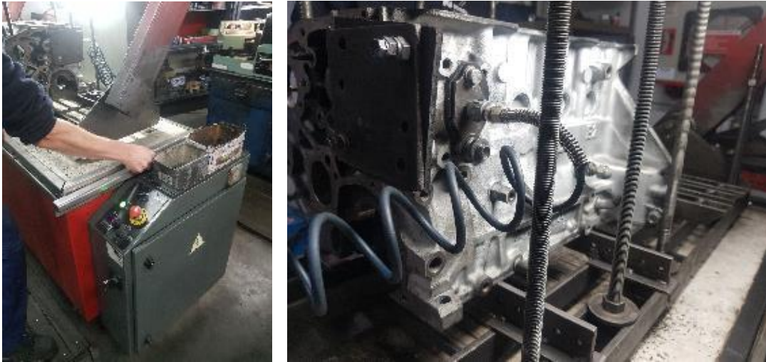
Figura 3-125 - Equipamento de teste e introdução de ar comprimido no circuito de água.
