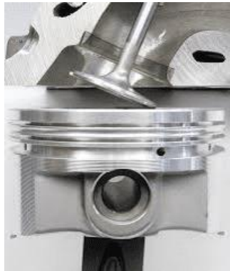
Figura 3-73 - Pistão a bater nas válvulas empenando-as.
