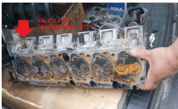
Figura 3-1 - Sensor de temperatura NTC na culassa do motor
