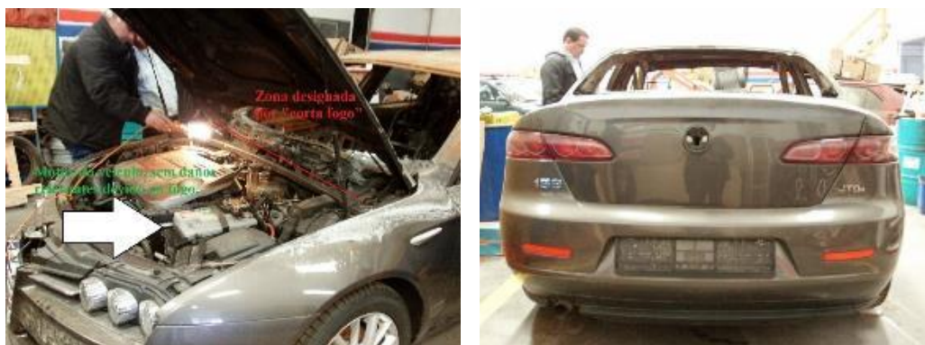
Figura 3-111 - Zona do motor, sem sinais de incêndio, apenas com alguns componentes plásticos escurecidos.
