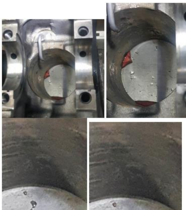
Figura 3-127 - Camisa com fissura.
