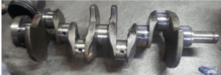
Figura 3-30 - Cambota com danos.
