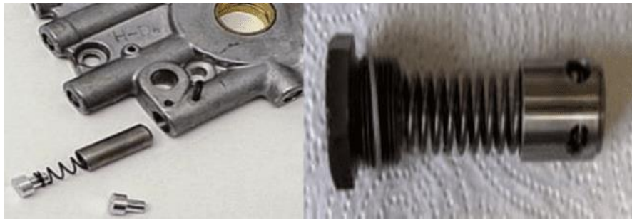
Figura 3-17 - Imagens de duas válvulas limitadoras de pressão de bombas de óleo.
