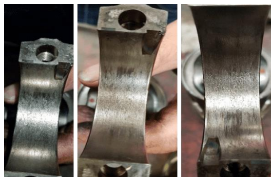
Figura 3-34 - Desgaste das bielas por fretting .
