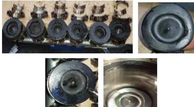
Figura 3-135 – Danos observados nos pistões.
