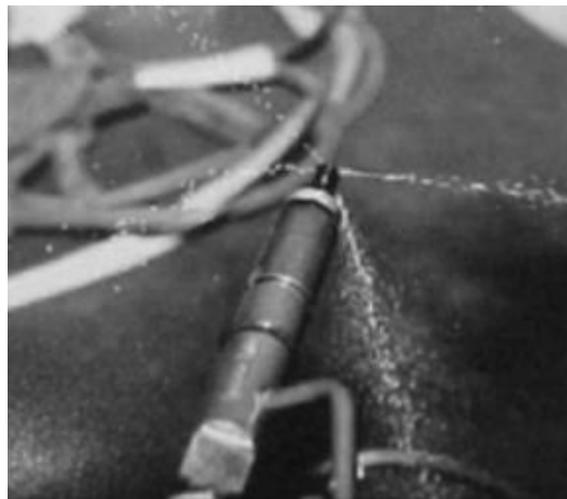
Figura 2-20 - Gotejamento ou pulverização deficiente do injetor. (Wielligh, Burger. e Wilcocks, 2003)
