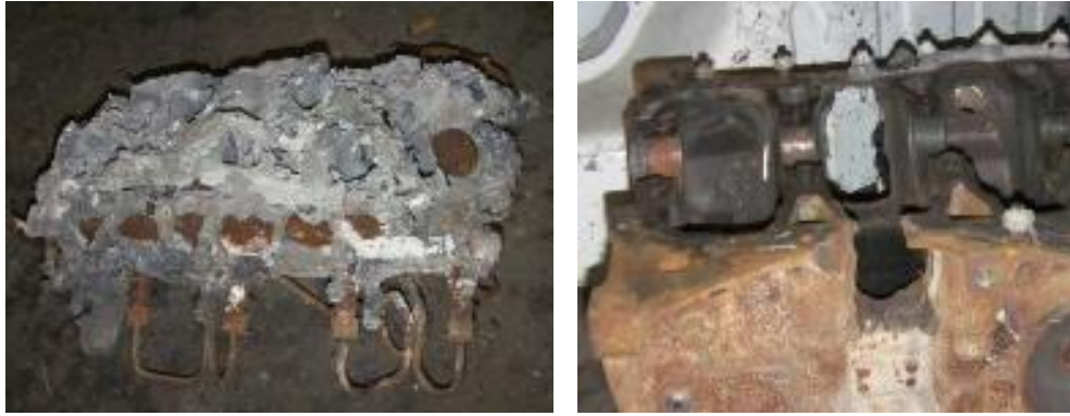
Figura 3-104 - À esquerda o estado de fusão que o incêndio provocou, e à direita os rombos.
