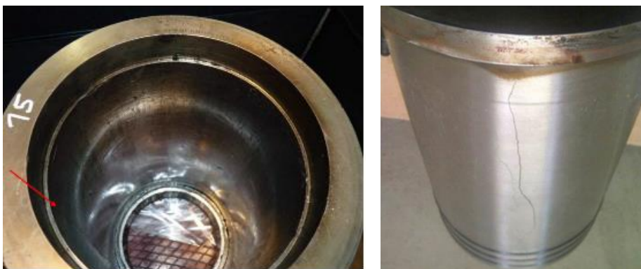
Figura 3-156 - Fissuras na camisa do cilindro.
