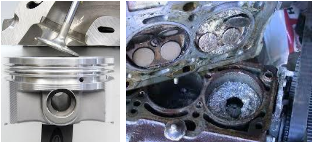
Figura 2-16 - Pistão a bater numa válvula por haver desfasamento (falta de sincronismo) entre a cambota e a árvore de cames (à esquerda). Estado em que pode ficar um motor com este problema (à direita).
