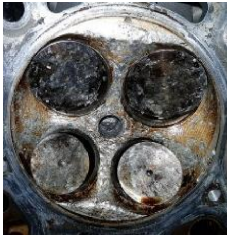
Figura 3-51 - Danos nas Válvulas do 2º cilindro que se encontram empenadas.
