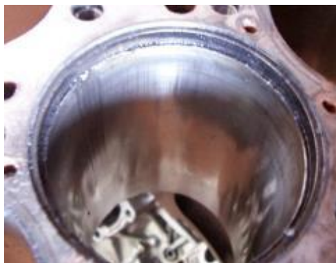
Figura 3-120 - Cilindro nº3 com a camisa partida pela gola.
