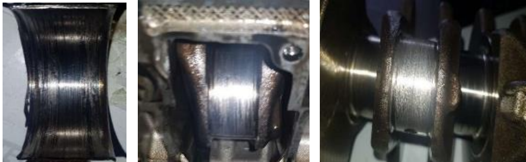
Figura 3-60 - Bronze de biela gripado à esquerda) e moente da cambota (à direita) gripado.
