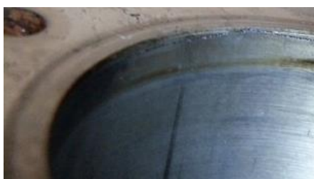
Figura 3-122 - Camisa do cilindro #4, onde se nota a camisa a partir pela gola.
