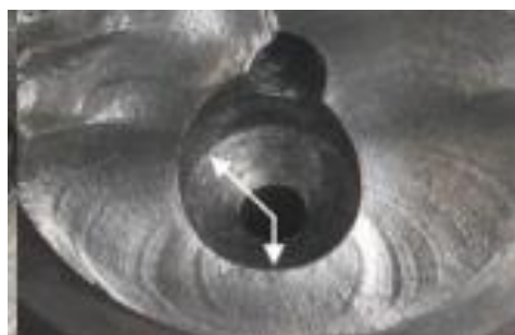
Figura 2-34 – Fratura na zona do furo de lubrificação, setas mostram as superfícies de fratura. (Fonte et al, 2015)
