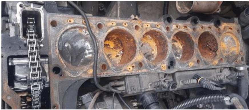
Figura 3-3 - Bloco do motor com os pistões gripados e marca de água nos cilindros
