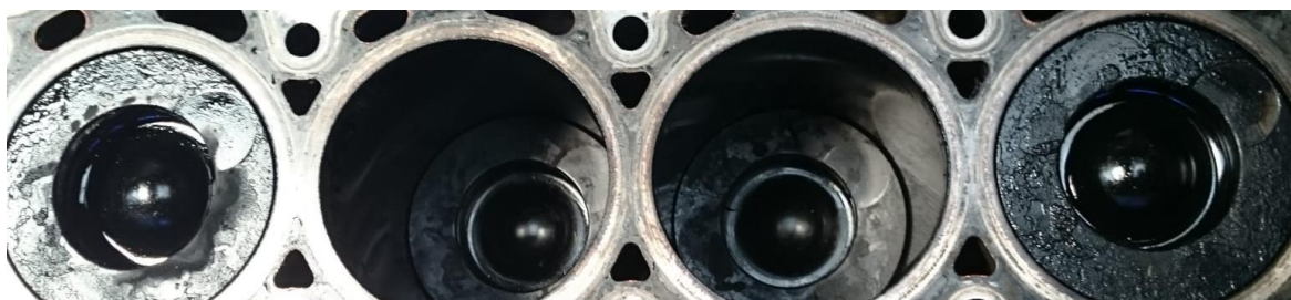
Figura 3-144 – Marcas nas cabeças dos pistões das válvulas de escape
