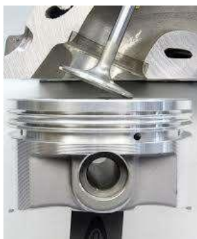
Figura 3-41 - Pistão a bater numa válvula por haver desfasamento entre cambota e árvores de cames e estado em que pode ficar um motor com este problema.
