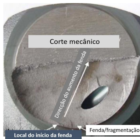
Figura 2-36 – Superfície de fratura no moente de apoio (Fonte et al, 2017)
