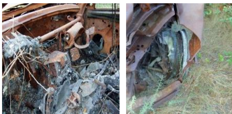
Figura 3-101 - Interior ardido (à esquerda) e jante esquerda fundida (à direita).
