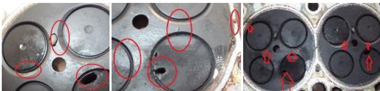
Figura 3-137 – Danos verificados na culassa e válvulas.
