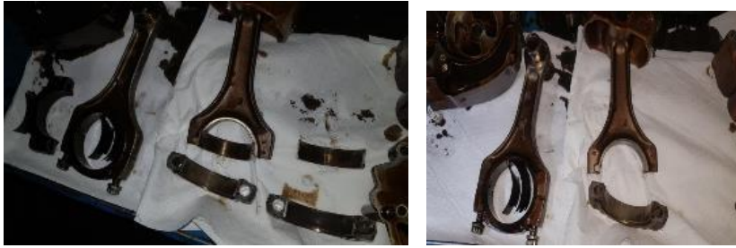
Figura 3-43 - Bielas e capas ou bronzes gripados.
