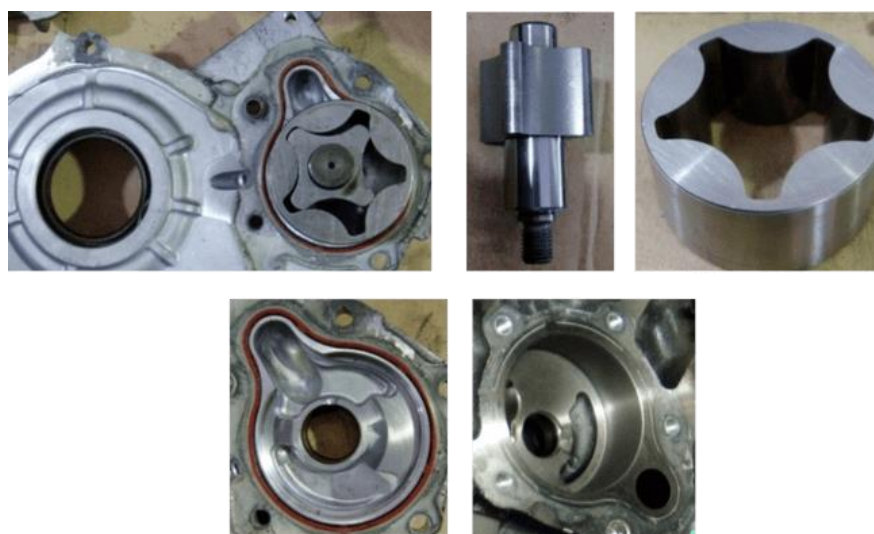
Figura 3-92 - Os vários componentes da bomba de óleo, em perfeito estado.
