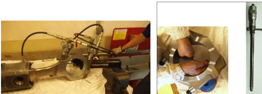
Figura 3-150 - Medição com micrómetro (precisão: 0,01 mm) de diâmetros interiores de uma cabeça de tirante, e de acordo com a Tabela fornecida pelo Fabricante.
