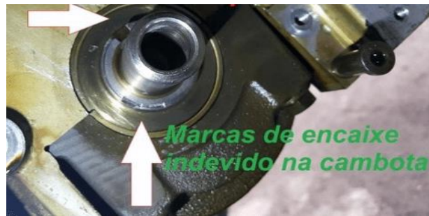
Figura 3-71 - Ranhura da cambota e marcas do aperto fora da ranhura.
