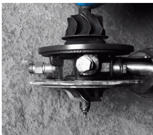
Figura 3-15 - Danos na turbina, parte de cima da imagem.
