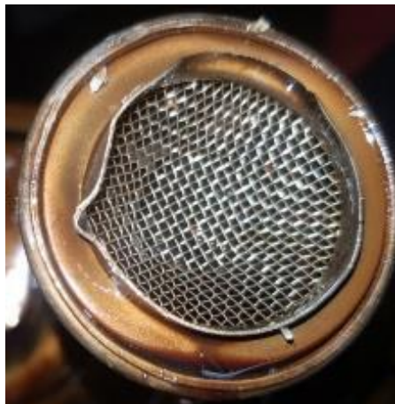
Figura 3-48 - Filtro de sucção ou aspiração deformado.
