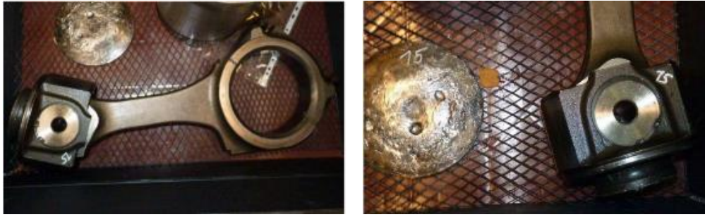
Figura 3-153 - Biela gripada (à esquerda) e pistão partido (à direita).
