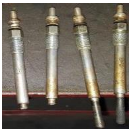
Figura 3-130 - Velas de incandescência partidas.
