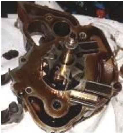
Figura 3-46 - Bomba de óleo em bom estado.
