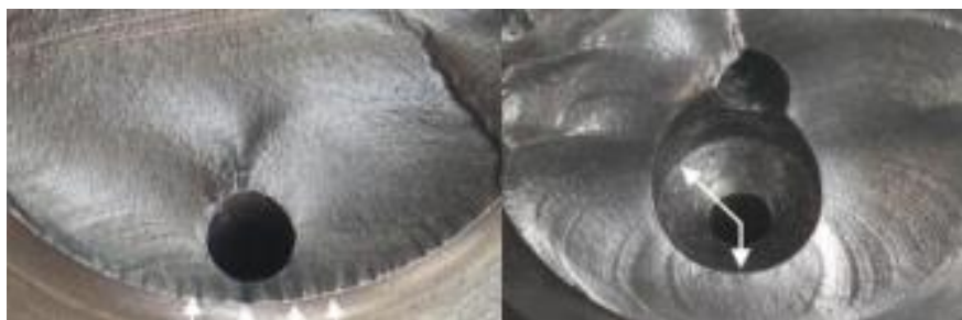
Figura 2-33 – Superfícies de fratura das duas cambotas. (Fonte et al, 2015)
