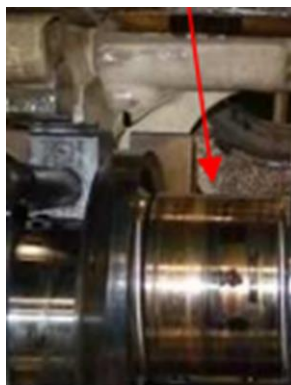
Figura 3-160 - Moente da cambota gripado, seta a vermelho
