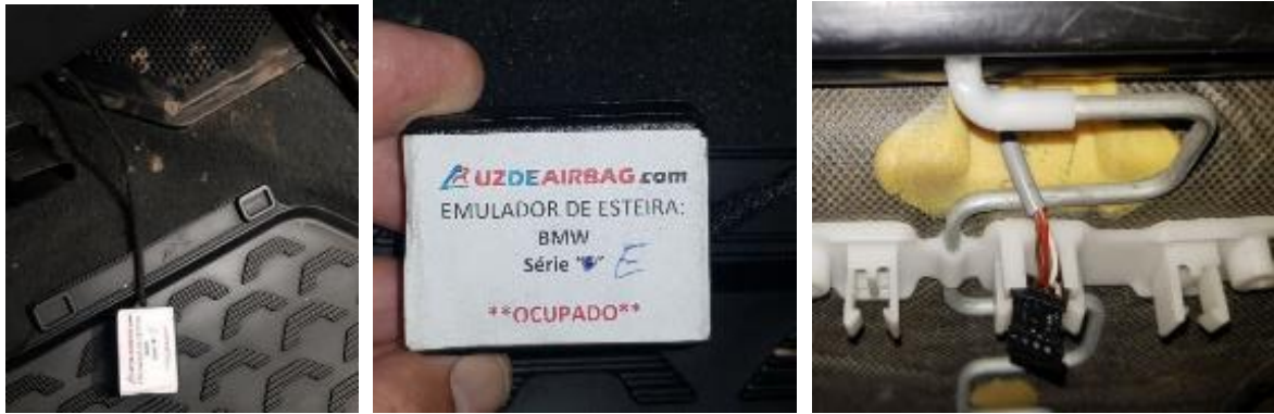
Figura 3-168 - Simulador de carga no sensor do banco do ocupante.
