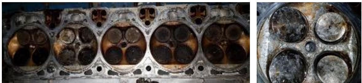
Figura 3-52 - Cabeça do motor com marcas de ter sido batida.
