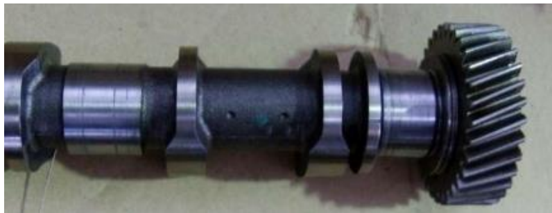
Figura 3-95 - Árvore de cames de admissão com apoio gripado.
