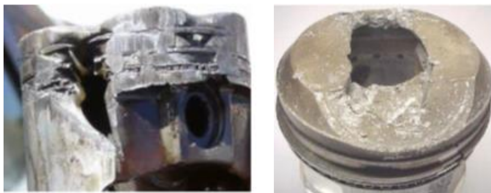
Figura 2-13 - Pistões danificados por Knock
