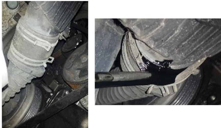
Figura 3-38 - Acumulação excessiva de óleo no intercooler .
