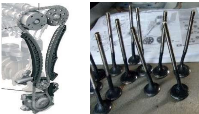
Figura 3-68 - kit de distribuição (à esquerda) e válvulas empenadas à direita).
