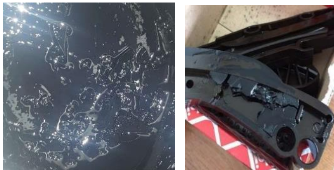
Figura 3-57 - Bocados do tensor depositados no cárter (à esquerda) e tensor estragado (à direita).
