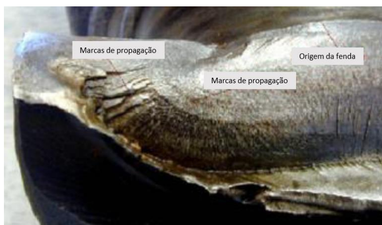
Figura 2-29 – Zona da fratura na cambota, marcas de propagação e origem da fenda. (Espadafor, Villanueva e García, 2009)
