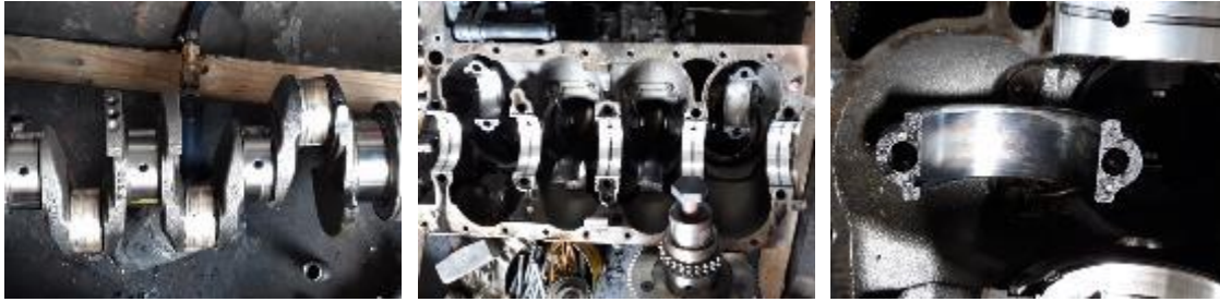
Figura 3-12 - Cambota (esquerda), apoios (centro) e biela com coloração (direita)
