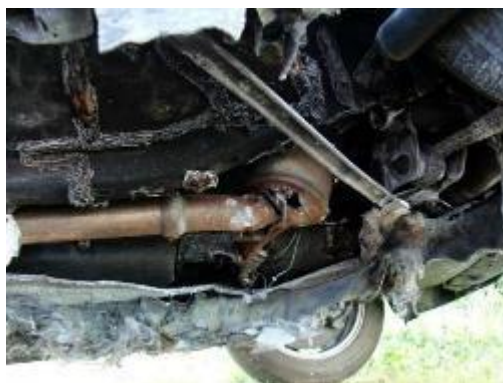
Figura 3-99 - Fenda na saída (jusante) do FAP.
