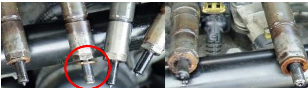
Figura 3-140 – Danos no injetor do cilindro #2.
