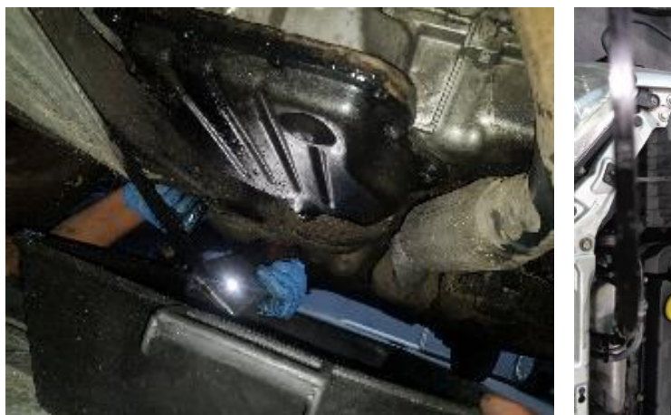
Figura 3-124 - Presença de água no cárter e vareta com nível acima do máximo.
