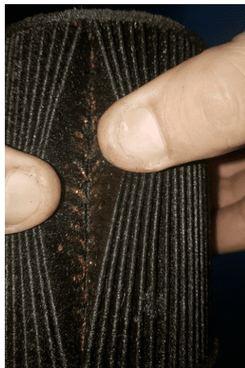
Figura 3-25 - Filtro de óleo contaminado
