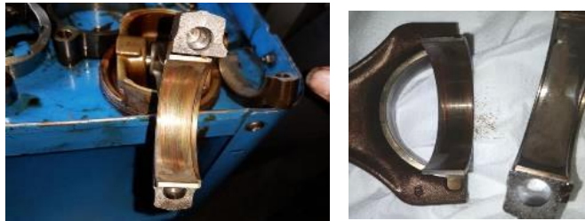
Figura 3-44 - Padrão de desgaste, cor acastanhada, demonstrativo de ter sido atingida a última camada de cobre e chumbo que protege a capa de aço.
