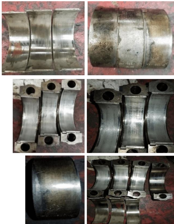
Figura 3-36 - Bronzes de biela com fretting nas costas e desgaste na superfície interior.
