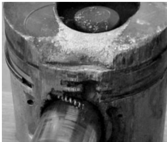
Figura 2-21 - Destruição da cabeça do pistão. (Wielligh, Burger. e Wilcocks, 2003)
