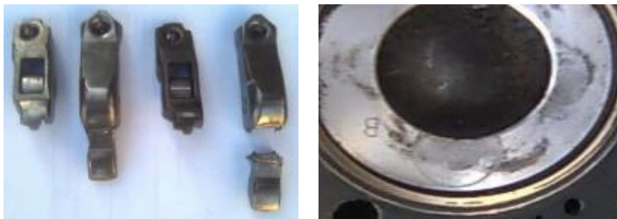
Figura 3-75 - Balanceiros partidos à esquerda) e marcas no pistão de ter batido nas válvulas (à direita).
