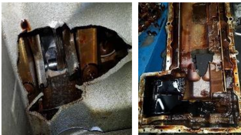
Figura 3-53 - Cárter partido apresentando dois rombos.
