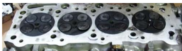
Figura 3-88 – Culassa do motor onde se notam as válvulas empenadas.
