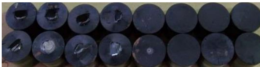
Figura 3-91 - As 16 touches das 16 válvulas, sendo que metade estão batidas.
