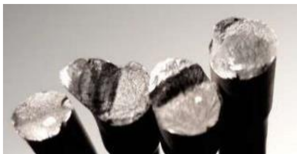
Figura 3-67 - Aspeto da fratura das 4 válvulas.
