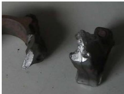
Figura 3-105 - Biela do cilindro#3 com fratura.
