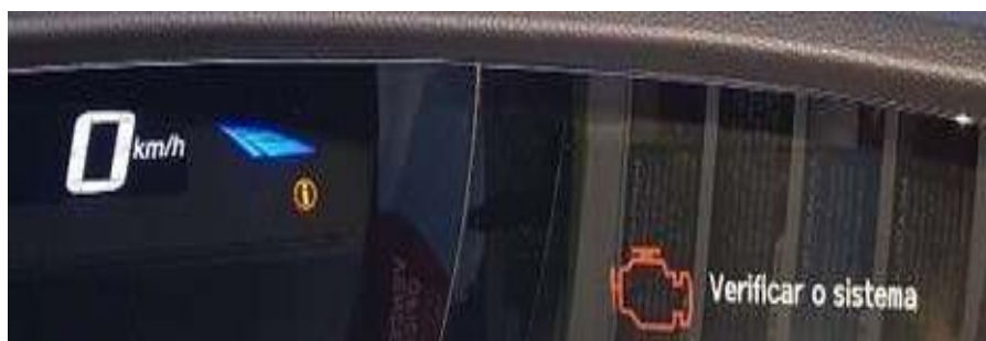
Figura 3-84 - Painel de instrumentos do veículo com avaria sinalizada.
