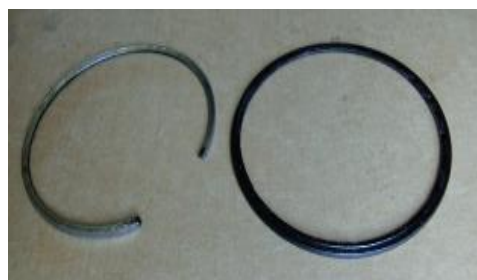
Figura 3-121 - Segmento de fogo partido (esquerda) e a gola do cilindro partido (direita) do cilindro #3
