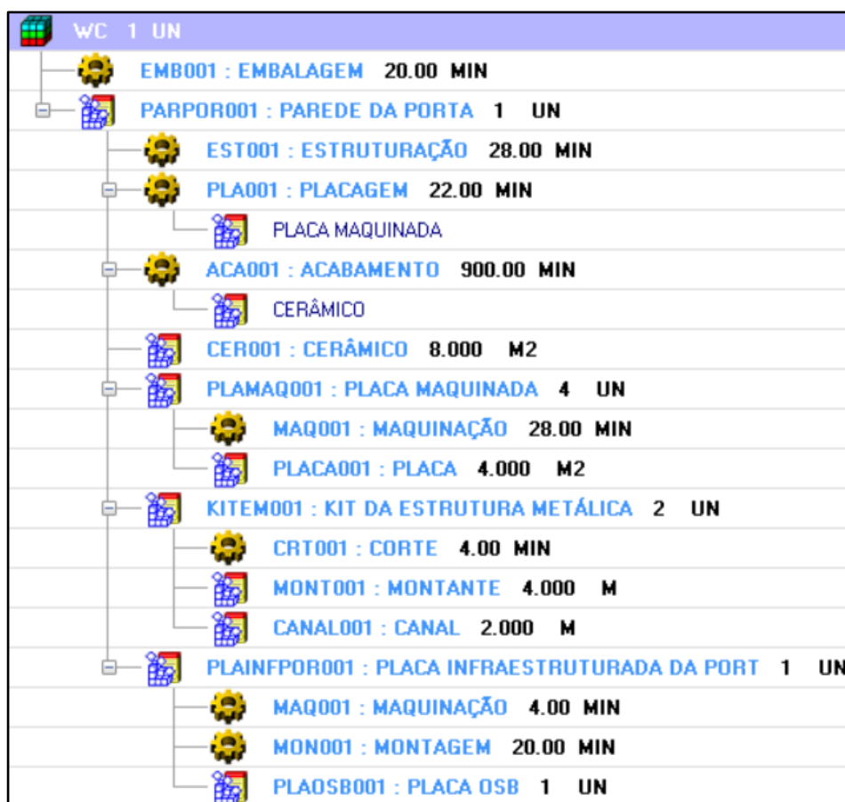
Figura 47 - Estrutura final do WC
