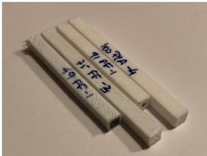
Figura 10: Fotografia dos quatro provetes de vigas bi-material sujeitos às análises de *DMA* (reproduzido de Magalhães, 2018 [2]).
