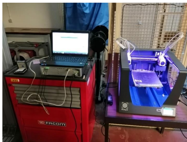
Figura 35 - Setup usado para a medição das vibrações criadas pela impressora 3D durante a concretização das trajetórias definidas
