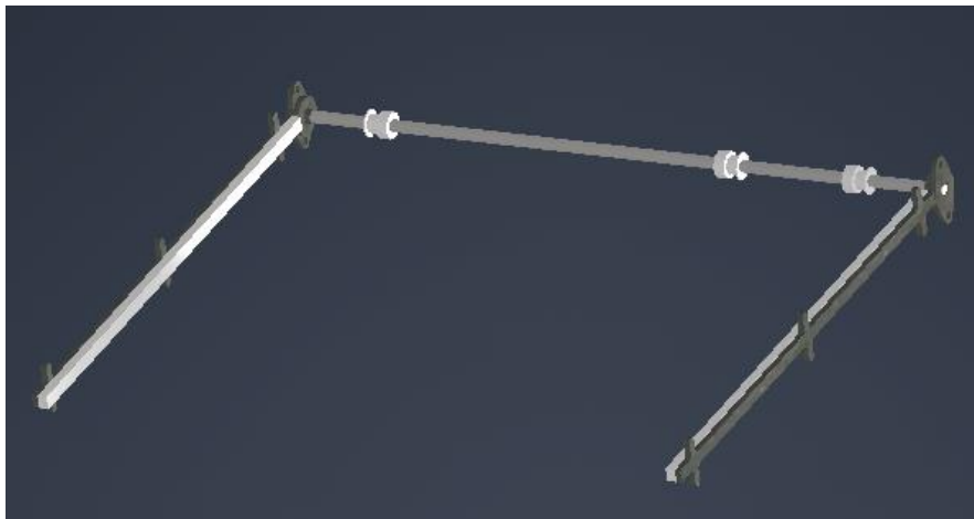
Figura 20 – Montagem do eixo y da impressora 3D
