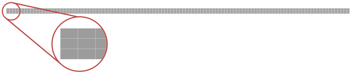
Figura 3.17 – Discretização da malha 2D com elementos Quad9 , com 3 elementos em espessura e 115 no comprimento.
