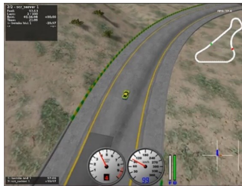
Figura 25 Captura de ecrã, da simulação em computador, de um veículo autónomo executando seguimento da trajetória das linhas amarelas usando algoritmos de Deep Reinforcement Learning . Fonte:[60].
