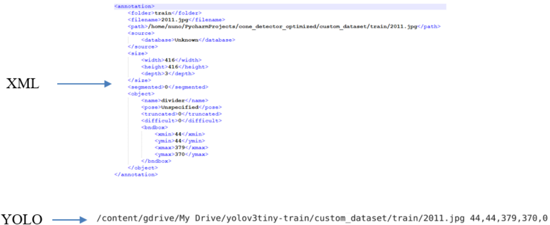
Figura 43 Exemplo de um ficheiro em formato XML e formato YOLO.
