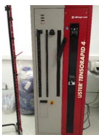
Figura 14. Equipamento Uster Tensorapid 4 de medição das propriedades de resistência mecânica.
