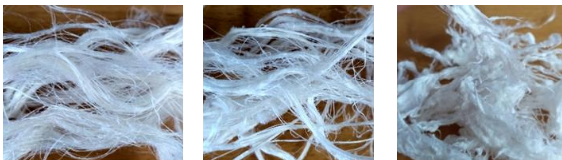
Figura 28. Amostras após tratamento na Branson Ultrasonics 3510 , HC 4030 Heraeus Vötsch com placa de aquecimento e AHIBA , respectivamente.
