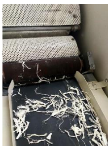
Figura 18. Carda de amostras, equipamento utilizado na individualização das fibras de Curauá.
