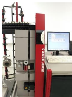
Figura 15. Equipamento Uster tester 5 de medição das irregularidades.
