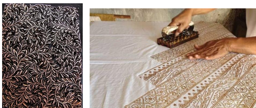
Figura 24: Cap - Carimbo de cobre à direita (Traders, Textile, 2020a) e processo do Cap batik à direita (The Handmade Romantics, 2020)
