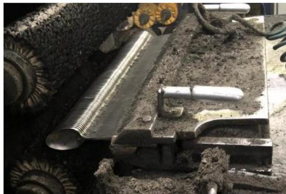
Figura 36 - Pente com peças, na máquina de brunimento à massa
