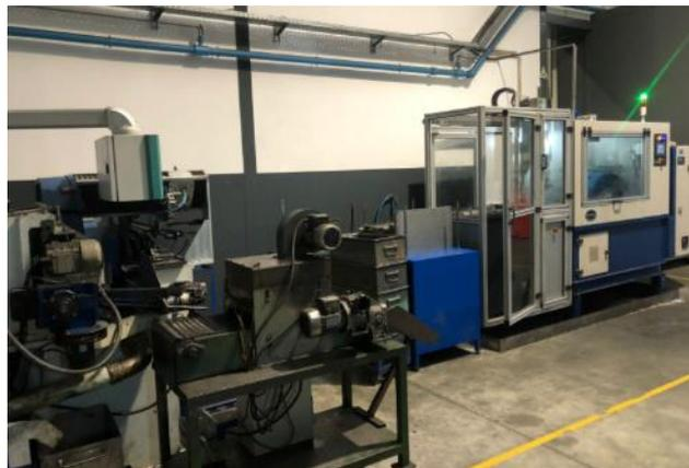
Figura 34 - Máquinas de serrilhar facas, dispostas no pavilhão 3
