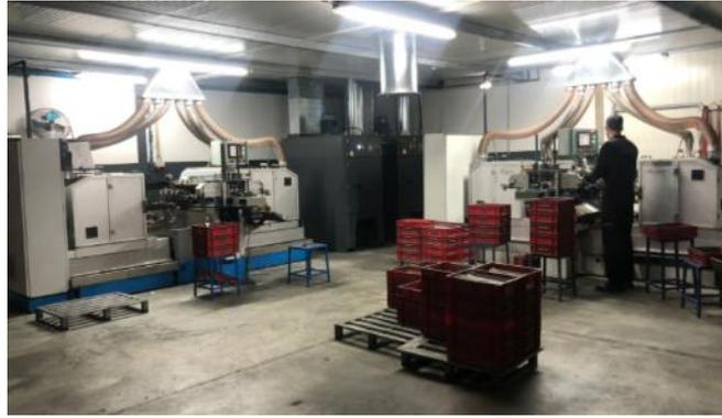
Figura 35 - Máquinas de lixar talheres, dispostas no pavilhão 3
