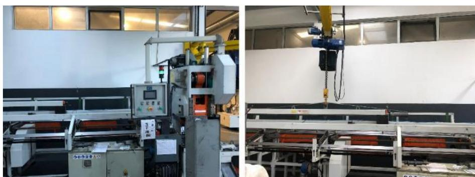
Figura 26 - Máquina de corte e braço robotizado, dispostos no pavilhão 4
