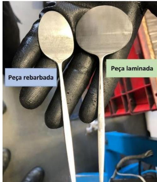
Figura 23 - Peça rebarbada e laminada lado a lado
