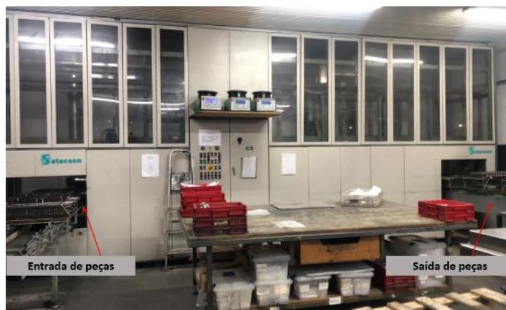
Figura 40 - Máquina de lavar peças saídas do polimento
