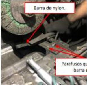
Barra de nylon. Parafusos que controlam a barra de nylon. | A barra deve estar alinhada para bater na parte larga do talher.<br>
