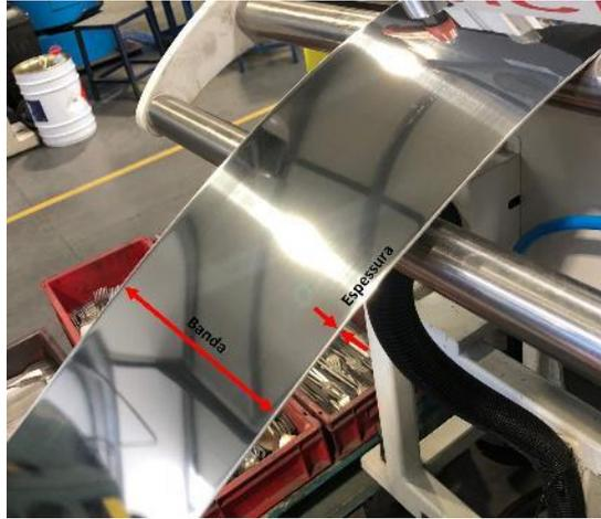
Figura 19 - Bobine de chapa com banda e espessura identificadas
