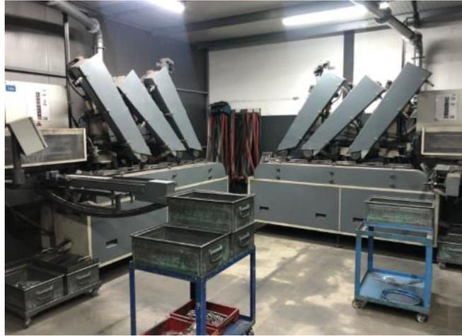
Figura 33 - Máquinas de lixar facas, dispostas no pavilhão 4
