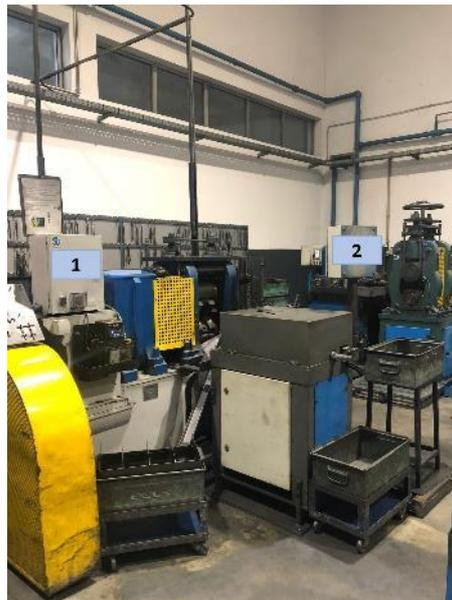
Figura 30 - Laminadores Longitudinais, dispostos no pavilhão 4
