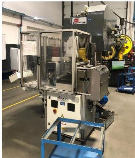
Figura 24 - Rebarbador automático, disposto no pavilhão 5
