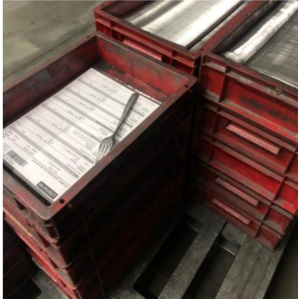
Figura 42 - Caixa vermelha com a OP e defeitos que acompanha todo o processo produtivo
