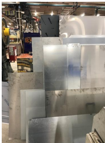
Figura 33 – Retalhos armazenados sem marcação
