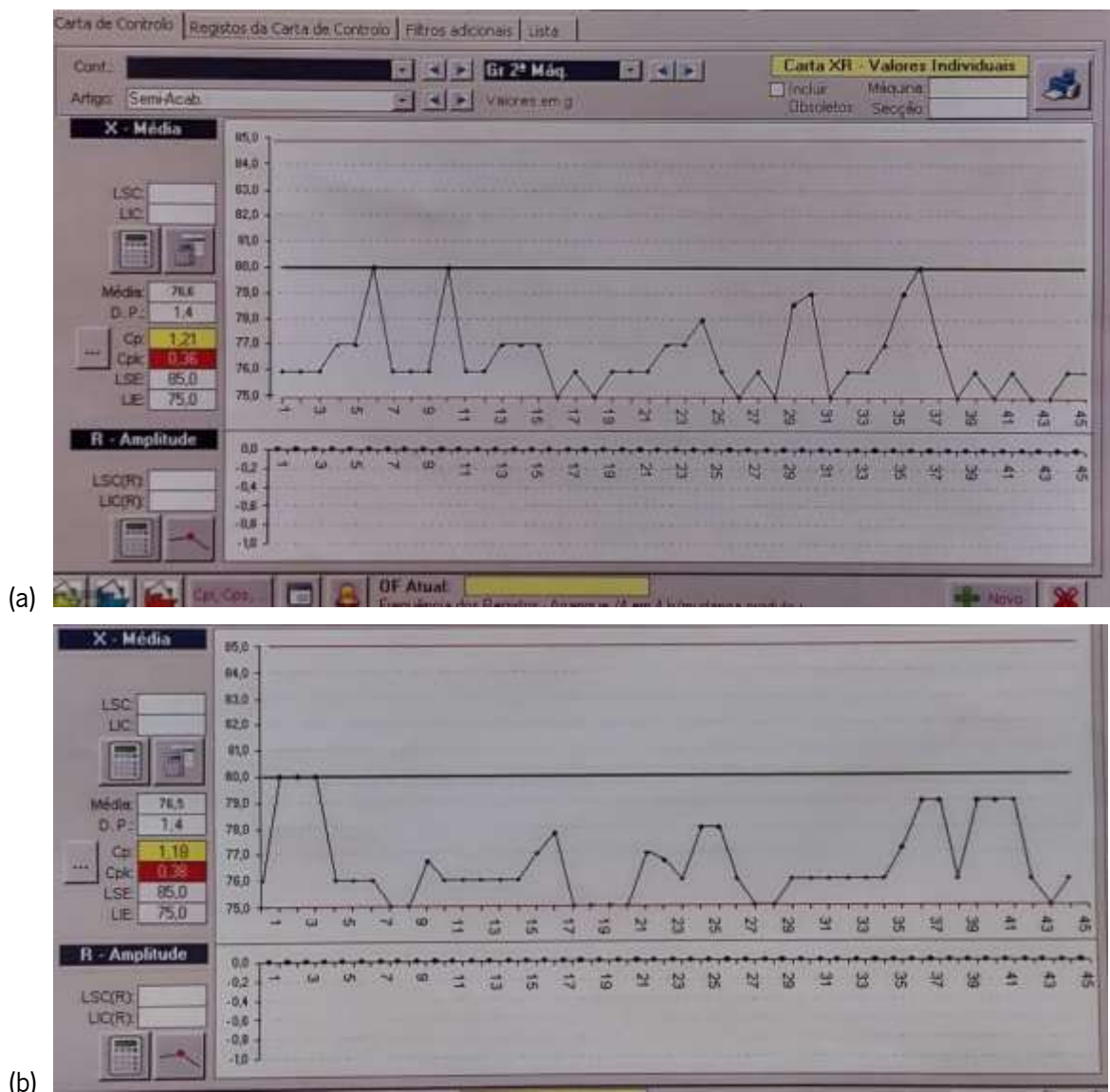
Figura 31 - Gramagem de cola na camada superior no estado inicial
