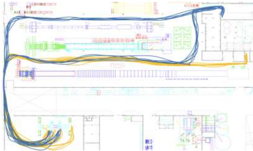
Figura 25 - Diagrama de Spaghetti a azul do caminho percorrido para as ferramentas (lixas) e a amarelo do caminho percorrido para as ferramentas manuais desde a pré-lixagem
