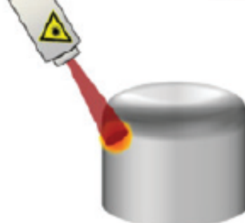
Figura 7 - Aplicação de tratamento térmico localizado via radiação laser [28].
