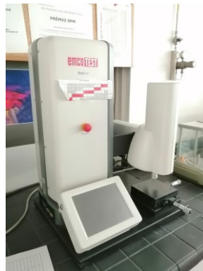
Figura 45 - Equipamento 'EMCOTEST', gerador automático do valor de microdureza.
