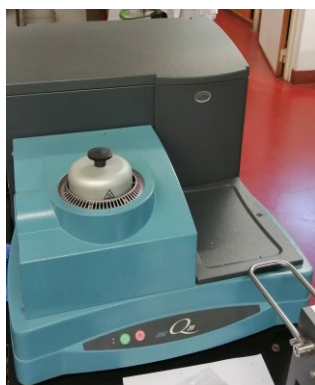
Figura 40 - Equipamento ' DSC Q20 ' utilizado na análise de calorimetria efetuada ao material AA 6063 T6.
