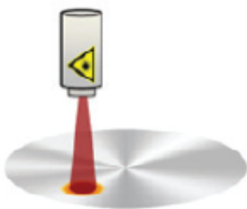
Figura 7 - Aplicação de tratamento térmico localizado via radiação laser [28].
