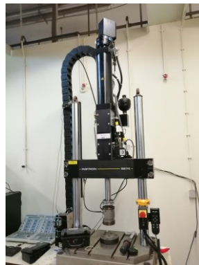
Figura 47 - Máquina universal de testes de tração utilizada para a determinação das propriedades mecânicas dos materiais.
