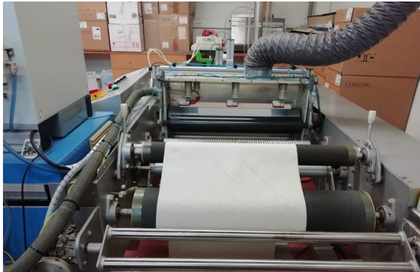
Figura 17 – Plasma atmosférico de descarga com barreira dielétrica (DBD)
