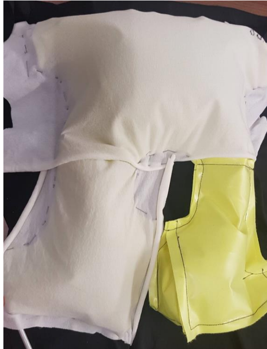
Figura 24 - Teste de insuflação com a camada exterior Fonte: Desenvolvido pelo autor (2020)
