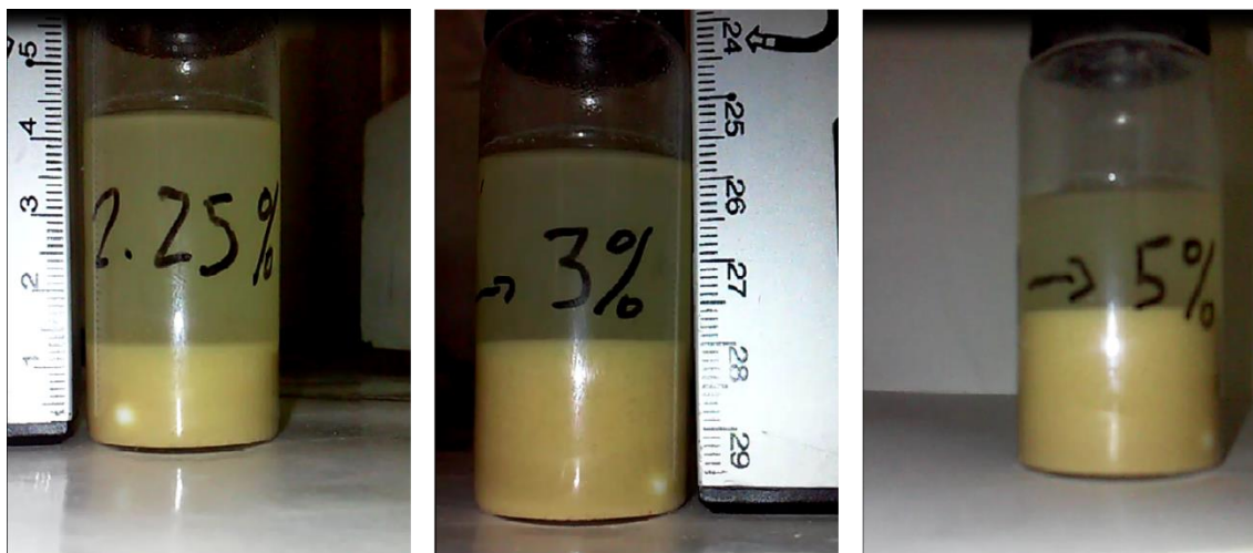
Figura 4.14 Suspensões de bentonita preparadas em 0.5% em peso de KIMNaik em NaCl 0.5 M contendo 2.25% em peso (esquerda), 3% em peso (médio) e 5% em peso (direita) de bentonita e representadas 3 minutos após cessação da agitação à temperatura ambiente.
