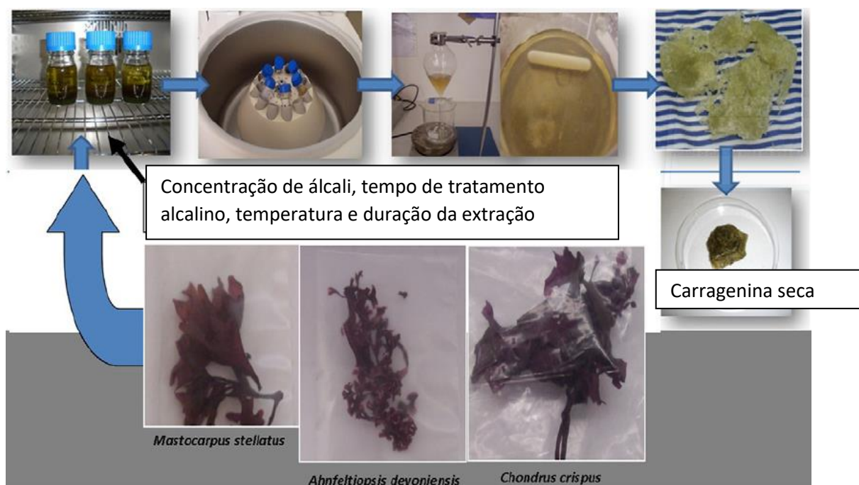
Figura 2.5 Processo de extração a quente de carragenina híbrida a partir de M. stellatus , C. crispus e Ahnfeliopsis devoniensis (adaptado de Hilliou, 2014).
