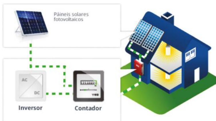
Figura 29 – Exemplificação de um sistema fotovoltaico (Fonte: ADENE).
