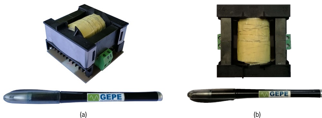
Figura 5.34: Protótipo do transformador de alta frequência: (a) vista frontal; (b) vista superior.
