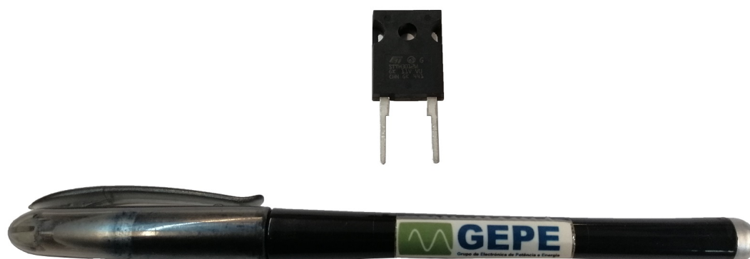
Figura 5.31: Semiconductor não controlado empregue no conversor CC/CC unidirecional não isolado do tipo boost - diodo STTH3012 .
