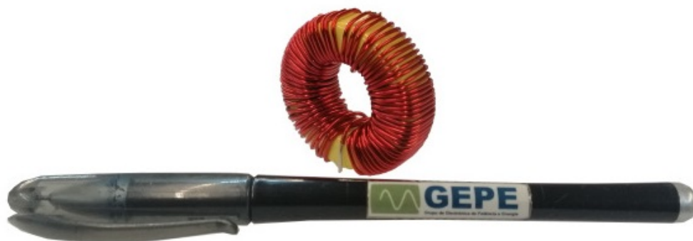
Figura 5.28: Bobina empregue nos conversores back-end .
