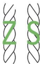
Figura 2.1 - Representação dos sentidos de torção de um fio têxtil.
