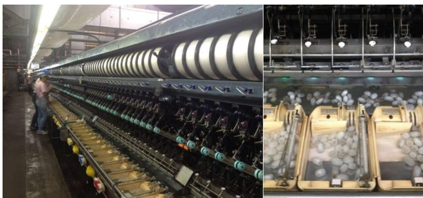
**Figura 3. 11-** Máquina de fiação automática (Arquivo da autora, 2017).
