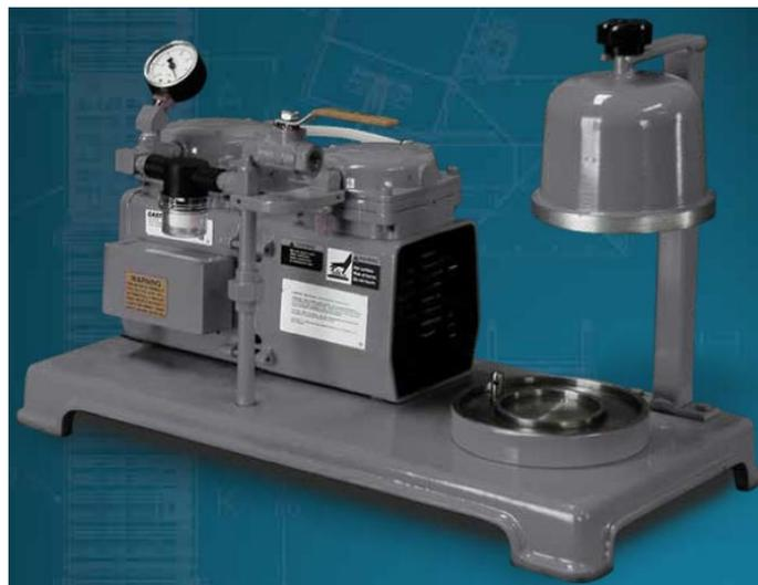
Figura 7 – Equipamento para o teste RPT (reproduzida de Porosity Solutions, s.d.).
