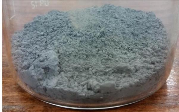
Figura 41 – Partículas cerâmicas após 3 horas de processamento no *ball milling*.
