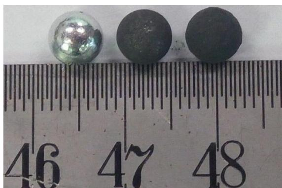
Figura 50 – Comparação entre esferas de 6 mm não processada (esfera da esquerda) e processadas sem (esfera central) e com bolas (esfera da direita).
