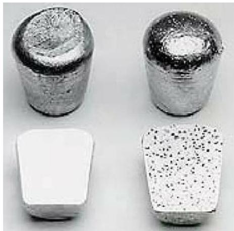
Figura 8 – Superfície de corte de duas amostras solidificadas em diferentes condições (reproduzida de Djurdjević, Ođanović, & Pavlović-Krstić, 2010).
