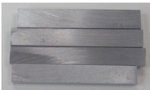
Figura 38 – Provetes do ensaio “A356 + SiC(1/49) + US” para o DMA.
