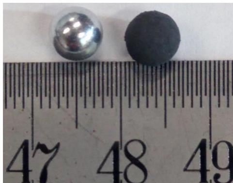
Figura 39 – Esferas de 6 mm com e sem revestimento de partículas cerâmicas.
