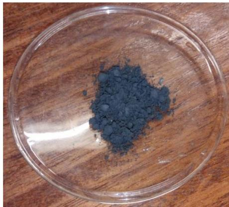
Figura 21 – Micropartículas de carboneto de silício.
