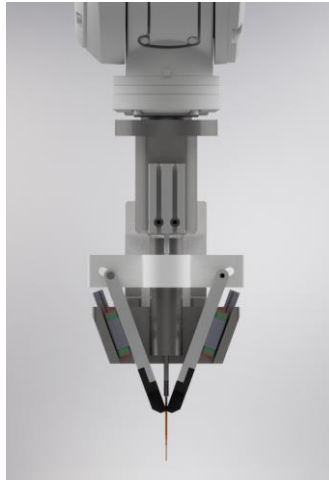
Figura 4-15 - Fixação do recetáculo.
