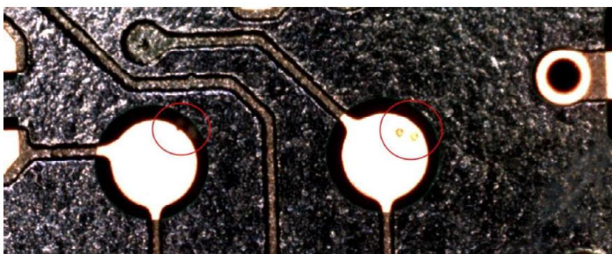
Figura 2-11 - Erro na picagem do PCB
