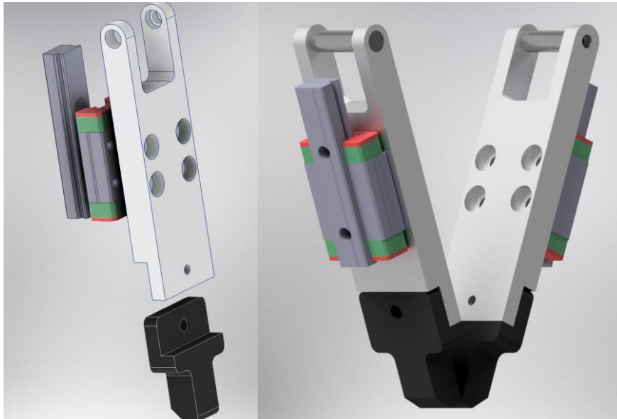
Figura 4-10 - Conjunto de fixação de recetáculo, com dedos da garra, guias lineares e borracha de contacto.
