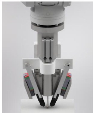
Figura 4-18 - Inserção do recetáculo.
