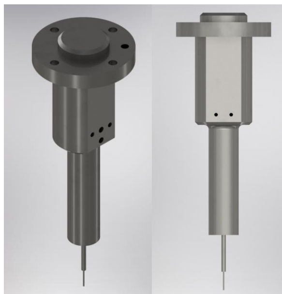
Figura 4-4 - Suporte central da garra com os furos para a placa de fixação à esquerda e para o cilindro pneumático à direita.
