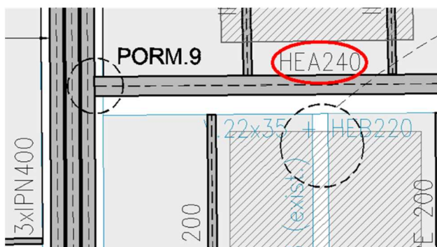
Figura 16 – Divergência entre planta e pormenor do projeto de Estrutura
