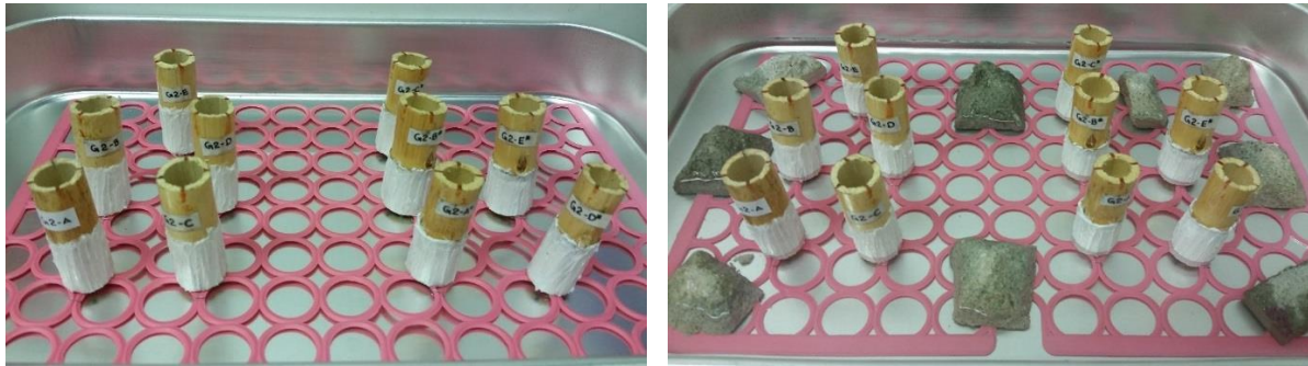
Figura 30 – Procedimento de ensaio de absorção de água por capilaridade na cana.
