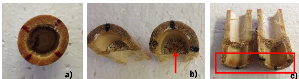
Figura 52 – Efeitos de ensaio em recipiente fechado. Saturação de água no topo da cana (a); fungos no nó (b); altura capilar na parede celular da cana (c).
