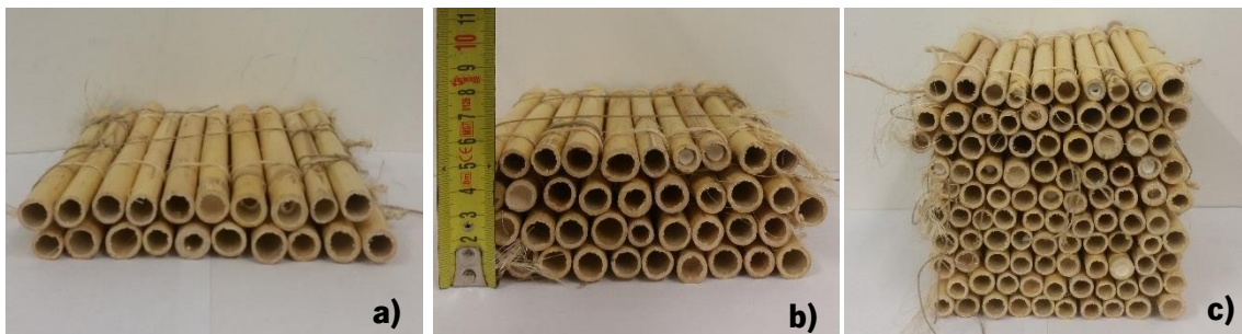
Figura 40 – Processo de sobreposição de esteiras a cada duas esteiras: duas esteiras amarradas (a); quatro esteiras formando o painel de 5 cm (b); sobreposição de dez esteiras para formar painel de 15 cm (c).
