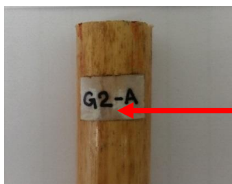
Figura 47 – Óleo no adesivo de identificação e alteração de cor.
