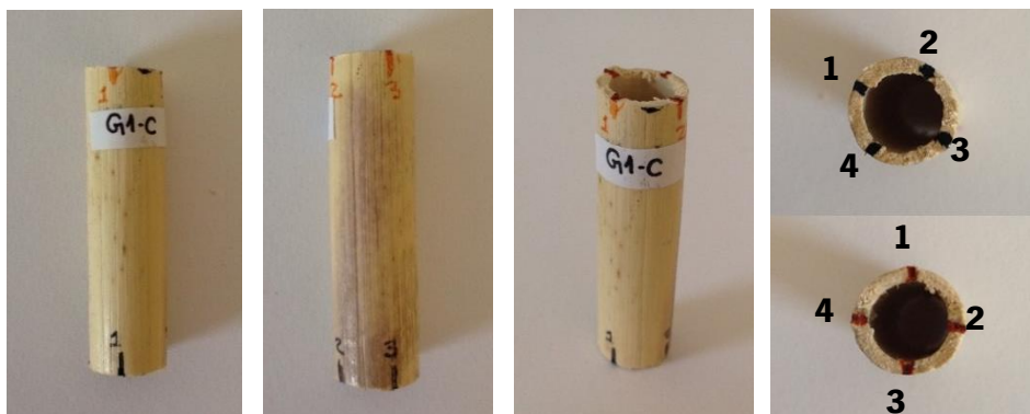
Figura 23 – Identificação das amostras e marcação ortogonal e numeração correspondente para medição periódica.
