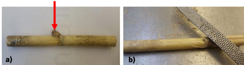
Figura 19 – Ramo que identifica a idade aproximada da cana (a); retirada do ramo e lixamento da superfície (b).
