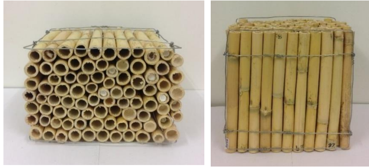
Figura 39 – Painel tipo caixa de 10 cm com hastes de cana inseridas de modo livre.
