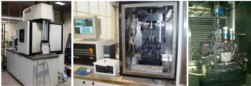
Figura 44. Equipamento usado para realização dos ensaios de módulo de rigidez e de resistência à fadiga
