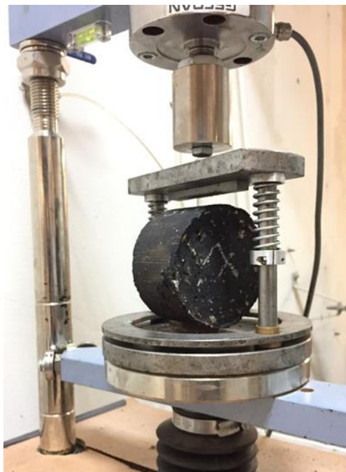
Figura 41. Equipamento utilizado para realizar o ensaio de tração indireta para posterior avaliação da sensibilidade à água
