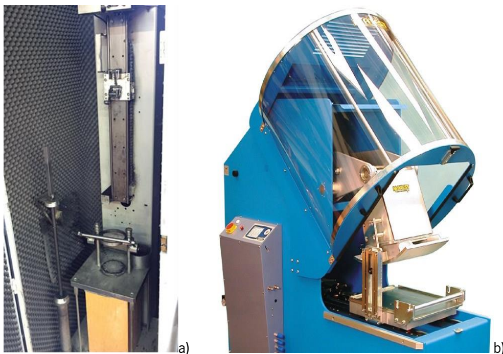
Figura 40. Equipamentos de compactação. (a) compactador de Marshall; (b) roller compactor.
