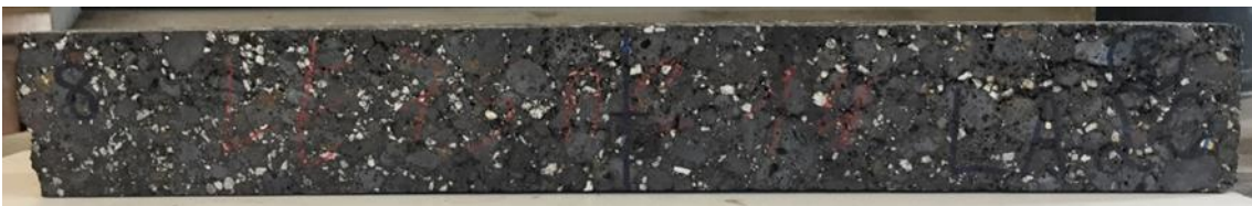
Figura 43. Vigas utilizadas para ensaio de módulo de rigidez e de resistência à fadiga ( 38 \times 5 \times 6,3 \text{ cm} )
