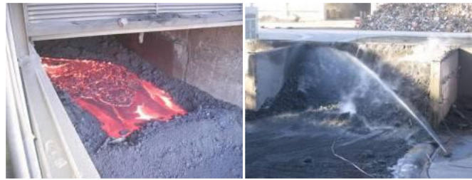
Figura 29. Arrefecimento da escória de aciaria (Ferreira, 2010)
