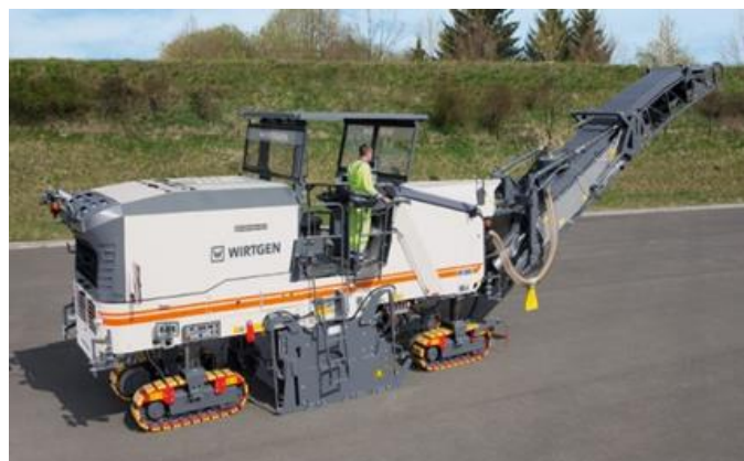
Figura 15. Equipamento utilizado para a fresagem de pavimentos (Wirtgen, 2017)
