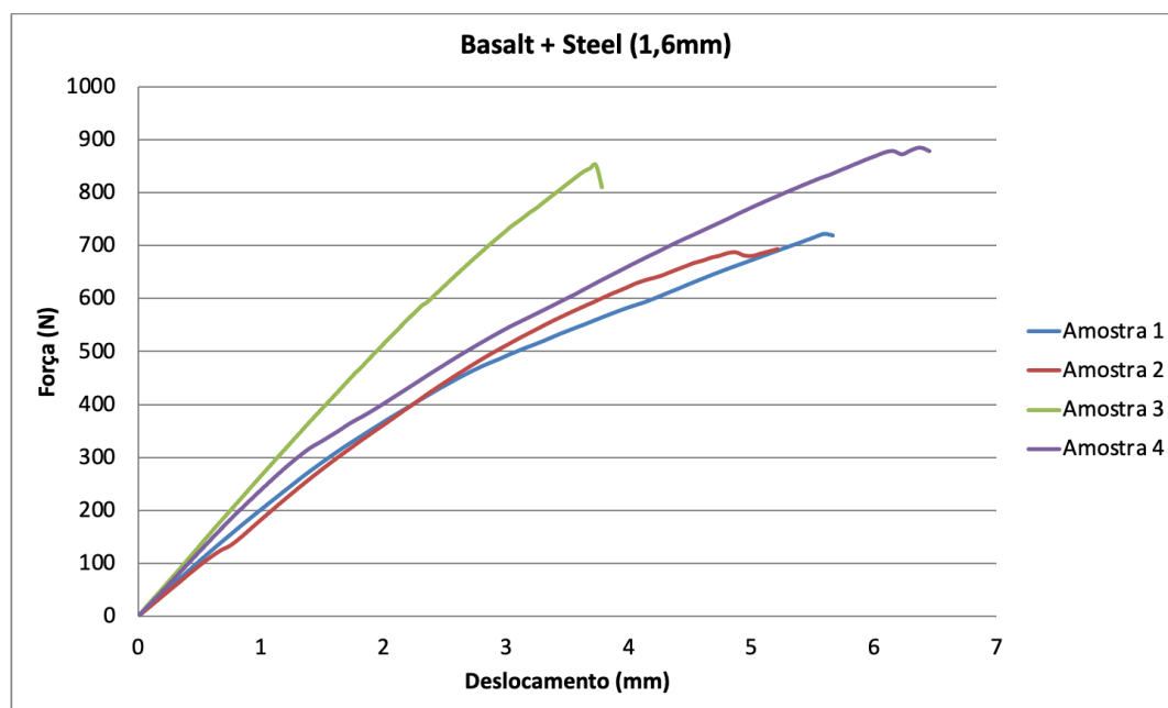
Figura 54 Diagrama de tensão vs extensão do BCR com fibra de basalto e filamento aço (1,6 mm).
