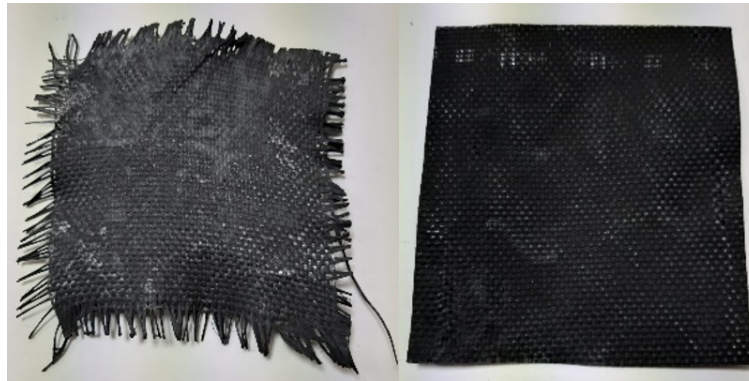
Figura 65 Aspeto visual das fibras impregnadas sem (à esquerda) e com (à direita) aplicação do tratamento de superfície prévio às mesmas.
