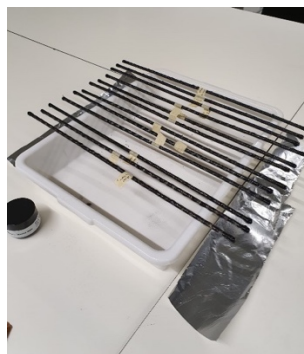
Figura 70. Preparação dos varões para ensaios de tração cíclica.
