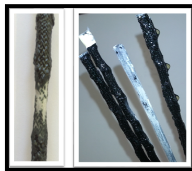
Figura 28 Aspeto do varão na fase inicial do processo de desgaste (esquerda); Aspeto final do varão após o desgaste (direita).
