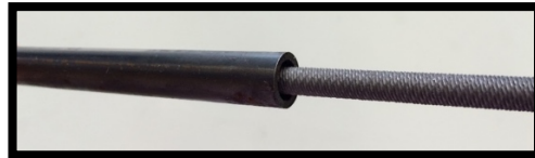
Figura 31 Processo de desgaste do interior dos tubos de aço.
