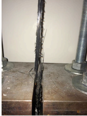
Figura 48 Aspecto final de um varão com núcleo de fibra de carbono após o ensaio de tração.
