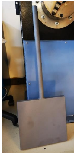
Figura 9- Placa de aço desenhada para enrolamento filamental e produção de provetes
