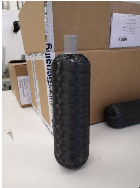
Figura 36- Reservatório Completo com Material de Matriz Termoplástica
