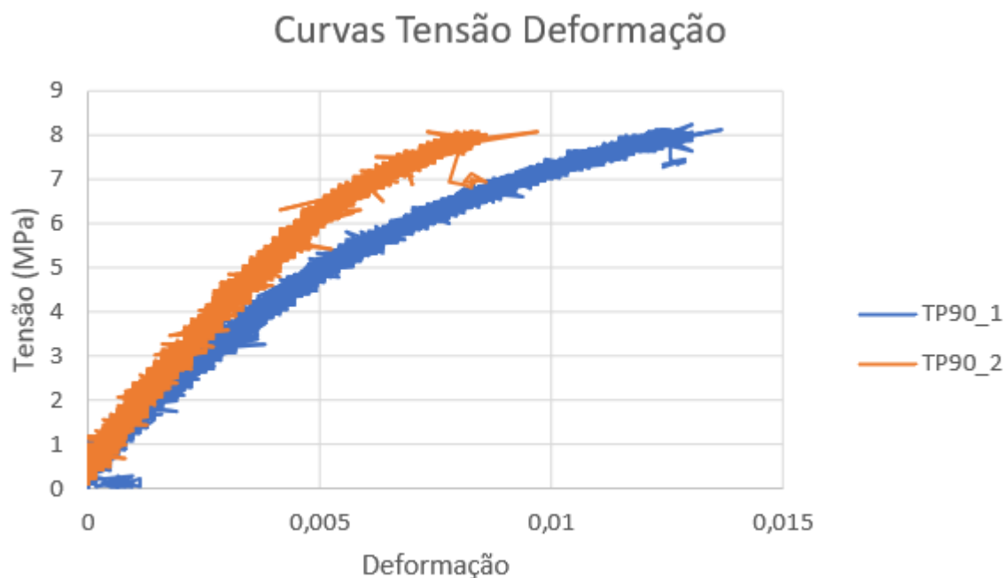
Figura 24- Curvas tensão-deformação nos provetes de PA12 reforçada com fibras de carbono a 90°
