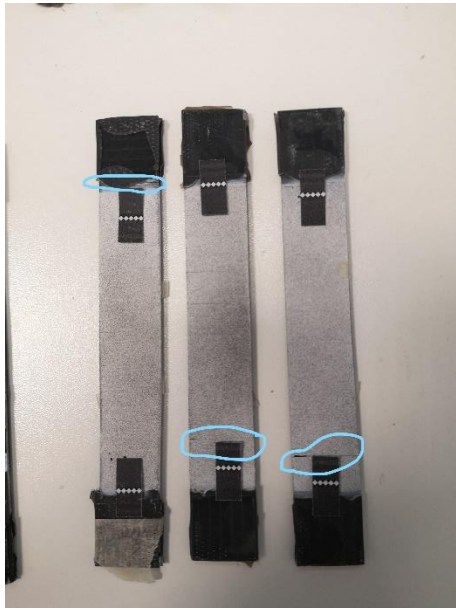
Figura 49- Provetes TP90 com Quebras após Ensaio
