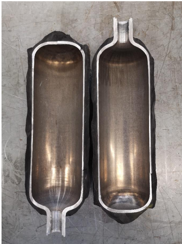
Figura 38- Corte Feito no Reservatório para Verificar Preenchimento da Resina
