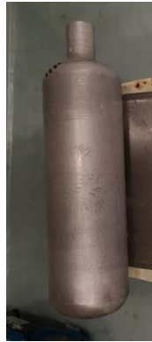
Figura 18- Reservatório Final em Alumínio para Enrolamento Filamentar
