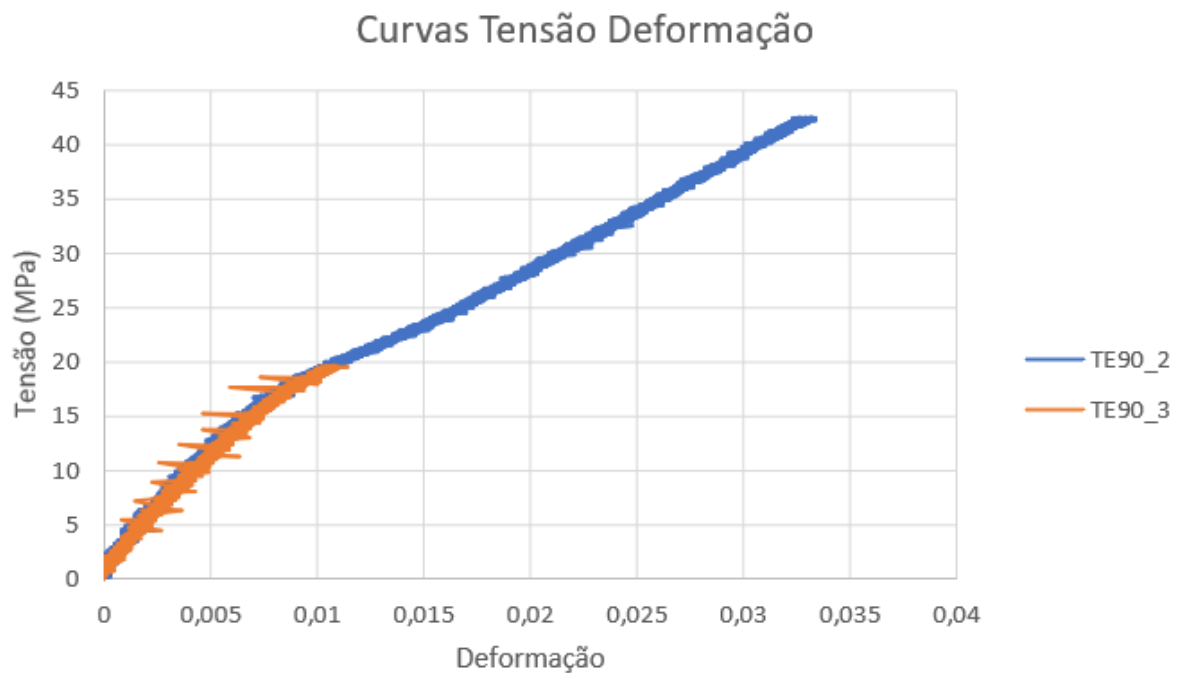
Figura 26-Curvas tensão-deformação nos provetes em resina epóxida reforçada com fibras de carbono orientadas a 90°
