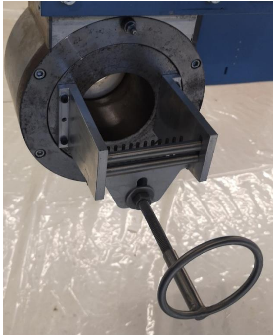
Figura 35- Cabeça de deposição final
