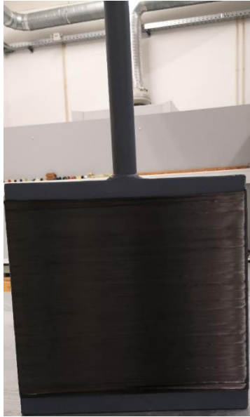
Figura 21- (a) Placa com fibras de carbono enroladas a seco
