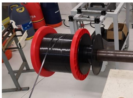
Figura 5- Fita Termoplástica utilizada para enrolamento de reservatórios e provetes
