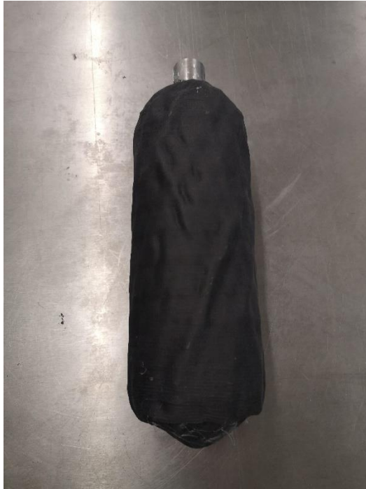
Figura 37- Reservatório Completo com Material de Matriz Termoendurecível
