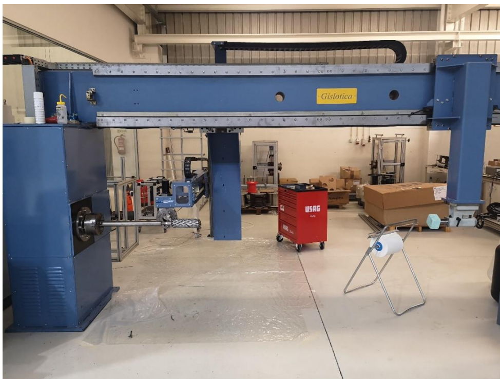
Figura 7- Máquina Utilizada na realização do Enrolamento de Liners e de Placas
