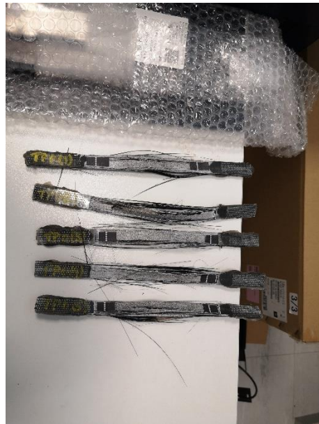
Figura 52- Provetes TPO após Ensaio
