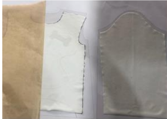
Figura 33 Colocação das ilustrações no molde. Papel impresso pronto para sublimação com papel de proteção sobre os mesmos. Fotografia: Tatiana Machado
