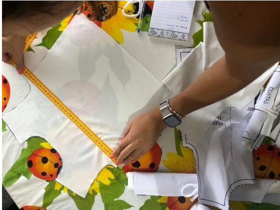
Figura 32 Medição do molde já cortado para ajustar os +8mm no programa CORELDRAR®. Fotografia: Tatiana Machado
