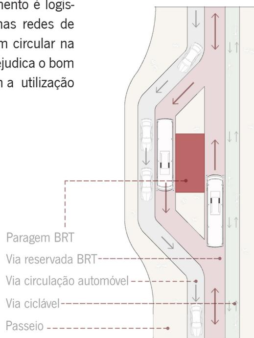
**Figura 47. Esquema de funcionamento de paragem BRT em planta**
