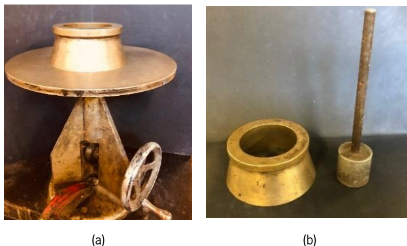
Figura 24. Mesa de espalhamento para o ensaio de consistência do compósito no estado fresco: (a) vista geral do equipamento; (b) detalhe do molde cónico truncado e soquete padrão.
