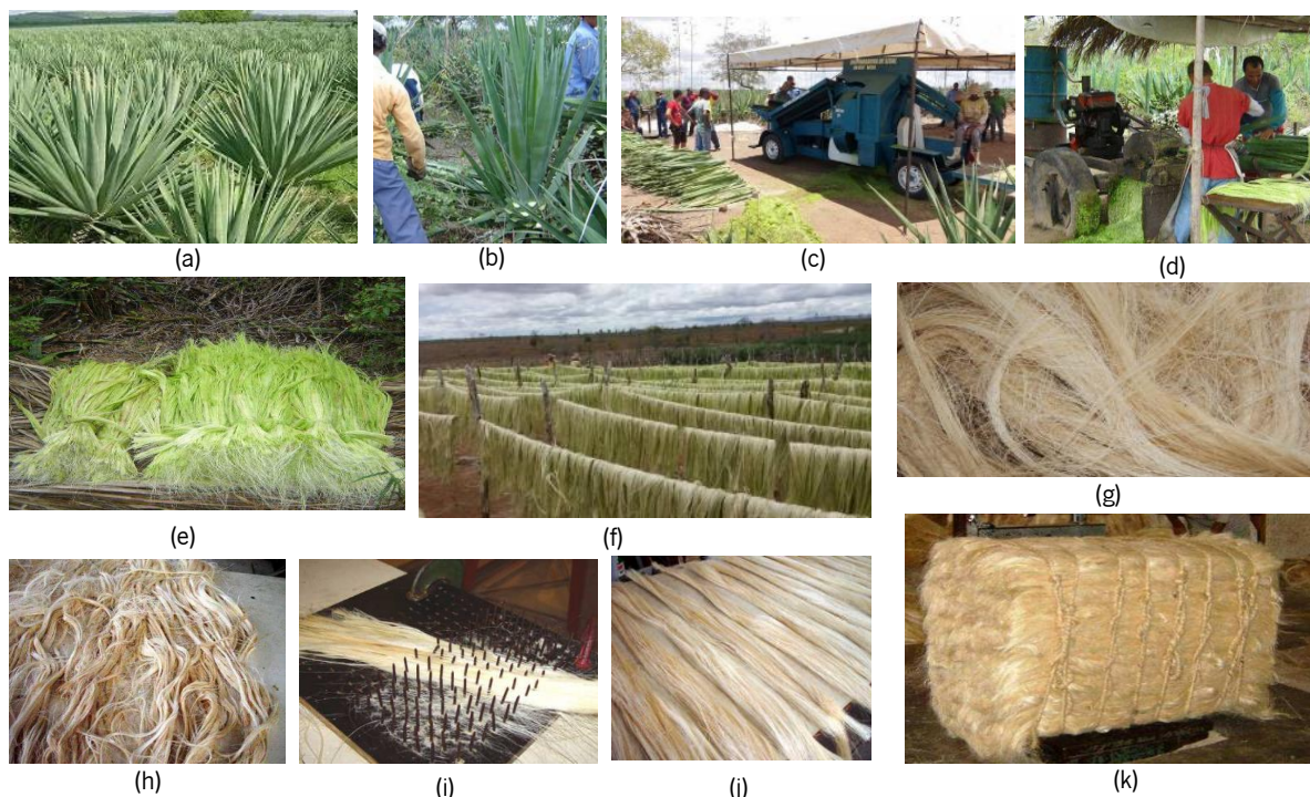
Figura 2. Cultivo da planta de sisal (a); colheita (b); desfibrilamento mecânico (c)(d); separação e secagem (e)(f)(g); beneficiamento com lavagem, desembaraçamento, alinhamento e corte (h)(i)(j); enfardamento (k).
