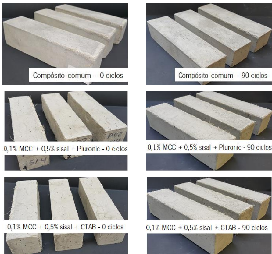
Figura 121. Compósitos cimentícios comum e multiescala antes e após 90 ciclos de envelhecimento.
