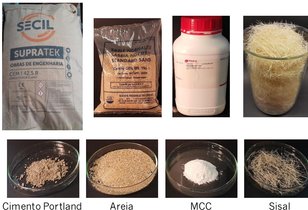
Figura 8. Materiais utilizados na preparação dos compósitos de matriz cimentícia: cimento Portland, areia normalizada, MCC e fibras de sisal – 20 mm.
