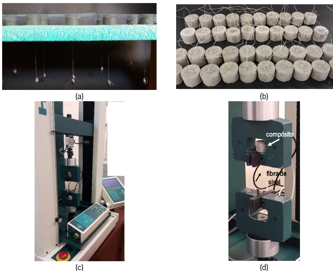
Figura 30. Ensaio de “pull-out” da fibra de sisal: (a) dispositivo para moldagem das amostras; (b) amostras dos compósitos reforçados com a fibra de sisal; (c) equipamento de “pull-out”; (d) detalhe do ensaio.
