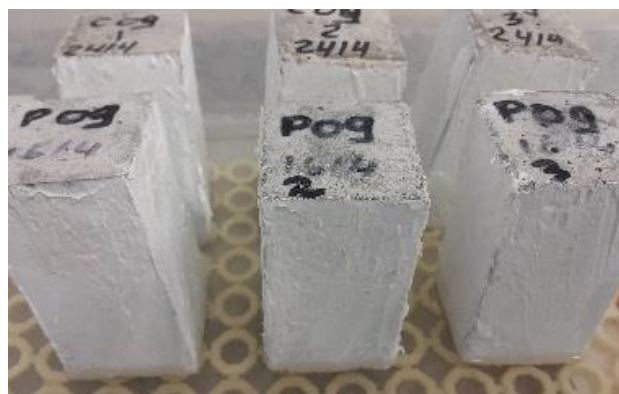
Figura 31. Ensaio de absorção de água por capilaridade.
