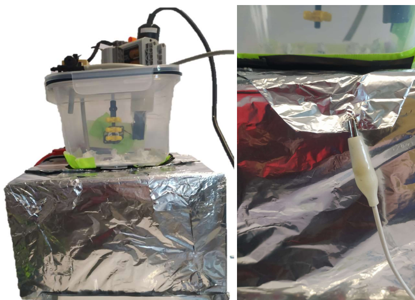
Figura 7.7 À esquerda- Setup com isolamento de alumínio. À direita- Pormenor da ligação do encapsulamento de alumínio à massa
