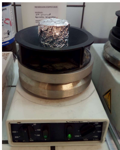
Figura 6.5 Agitador magnético com a mistura de quitosano, THF e PtOEP com proteção de alumínio
