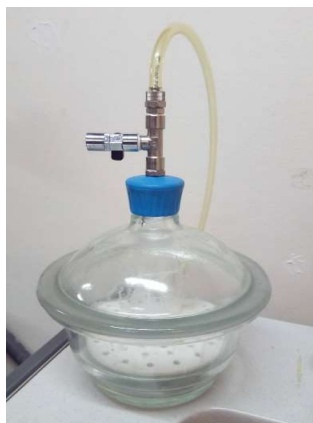
Figura 6.15 Processo de vácuo com o polímero resultante da mistura dos dois agentes de PDMS.
