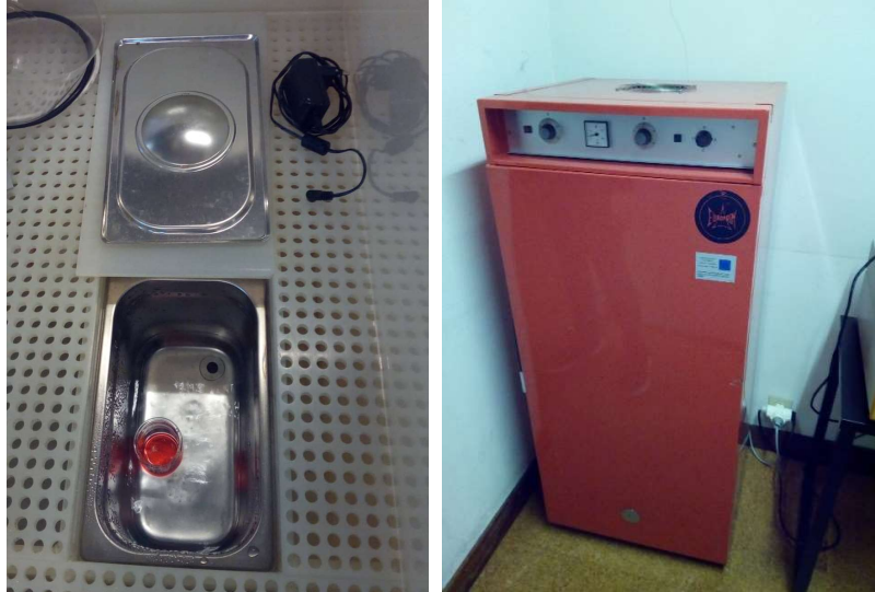
Figura 6.18 À esquerda - Ultrassom no processo de homogeneização da matriz. À direita - Processo de secagem na estufa.
