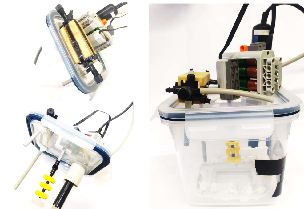
Figura 7.5 Fotografia das diferentes perspetivas da montagem do motor/bateria no recipiente de teste.
