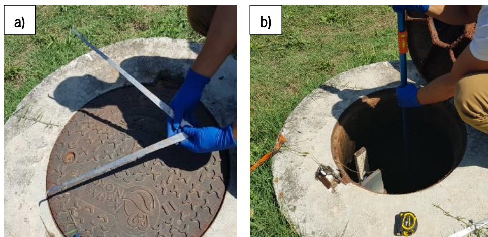
Figura 3-13: a) Instrumento para medição de diâmetro interno de coletores e b) Vareta extensível para medição de profundidades.
