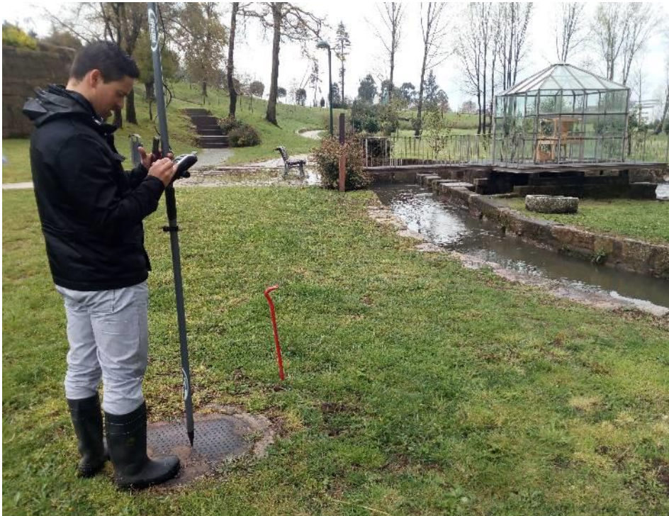
Figura 3-7: Levantamento topográfico na margem esquerda do Rio Pelhe.
