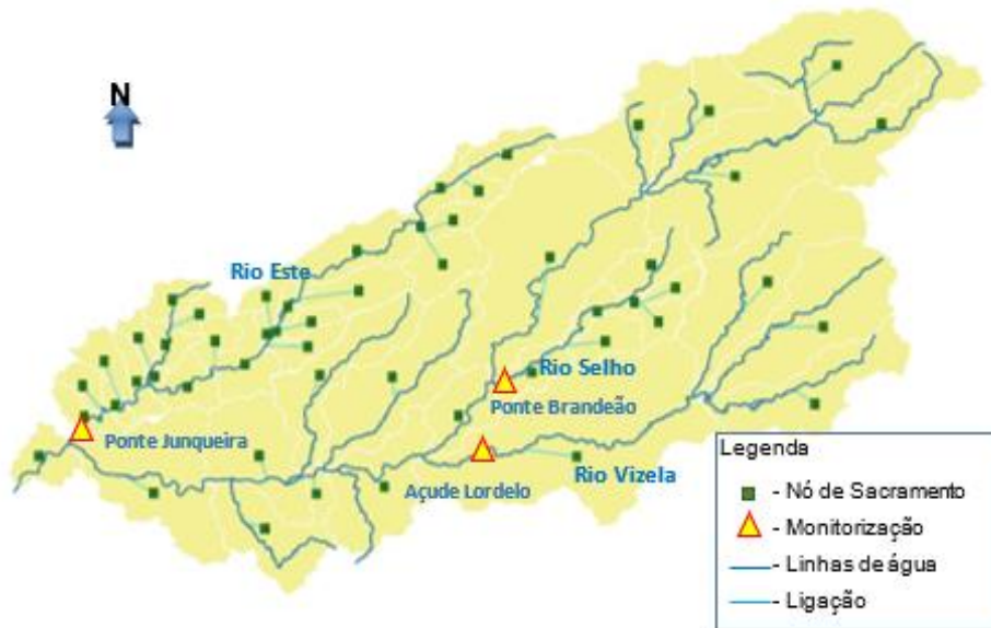
Figura 3-36: Discretização espacial do modelo hidrológico.
