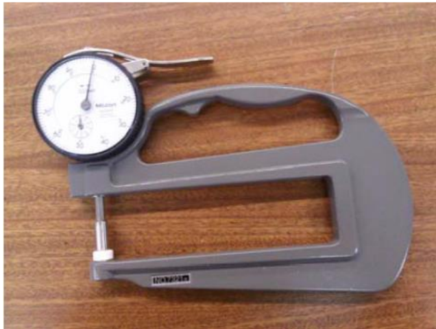
Figura 16 – Medidor da espessura do tecido Fonte: Mendes (2012)
