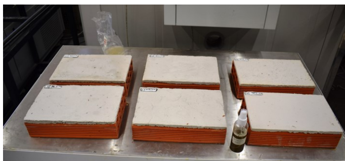
Figura 4-11 - Pulverização dos esporos nas amostras
