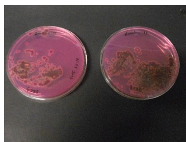
Figura 2-11 - Crescimento de fungos em meio DRBC - 3º dia - amostra 11 (edifício local IV)
