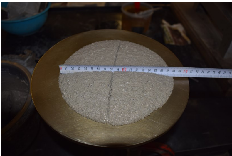
Figura 3-4 – Ensaio de trabalhabilidade
