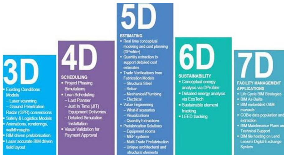
Figura 6 - Dimensões BIM [74]
