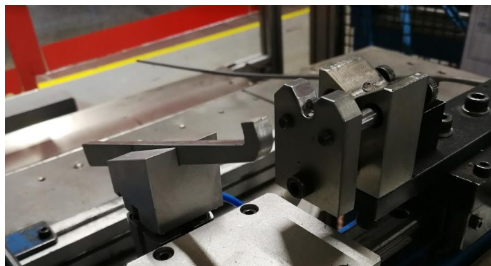
Figura 44 - Extrator pneumático implementado na máquina Zamak da Multi1
