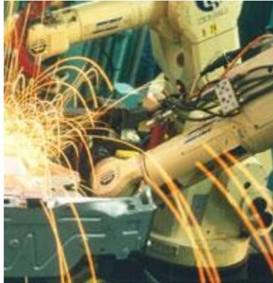
Figura 15 - Máquina de soldagem para componentes de automóveis[1].
