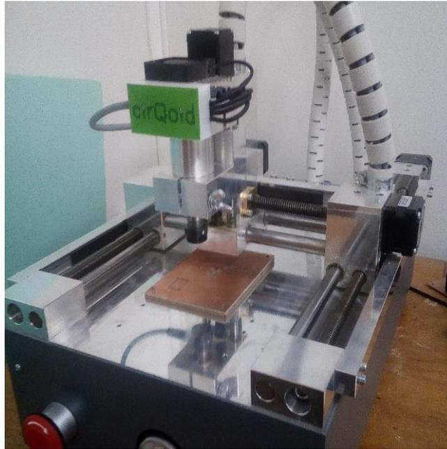
Figura 5- Aparelho utilizado neste projeto, este dispositivo recorre ao uso do sistema cartesiano (X, Y,Z) para proceder ao posicionamento.
