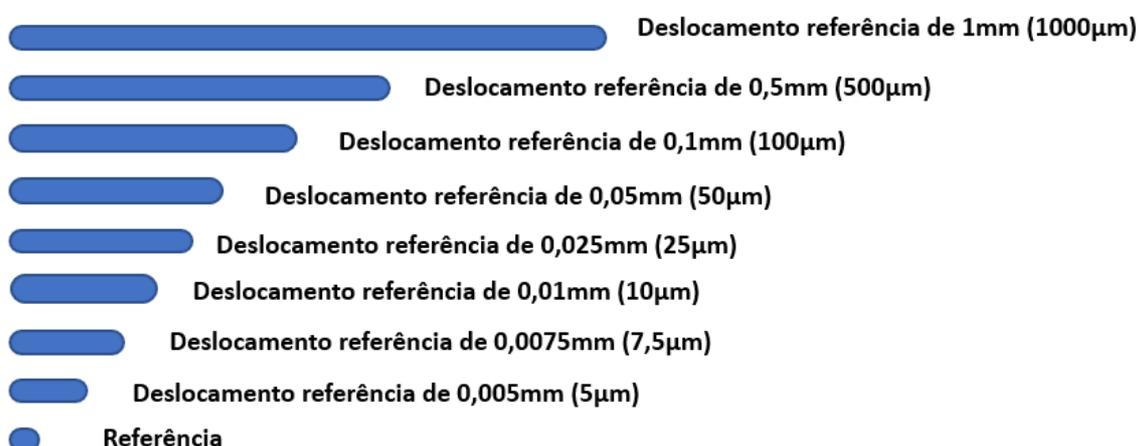
Figura 48 - Representação dos rasgos efetuados durante o teste de toleranciamento dimensional.
