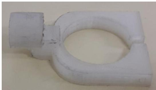
Figura 64 - Acessório 3D impresso em PLA, responsável pela acomodação da pistola de vácuo.
