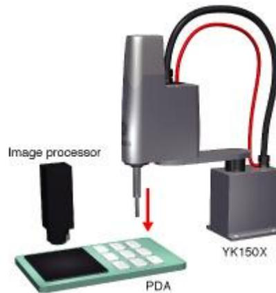
Figura 17 - Máquina de posicionamento *Scara* de teste de produtos finalizados[1].
