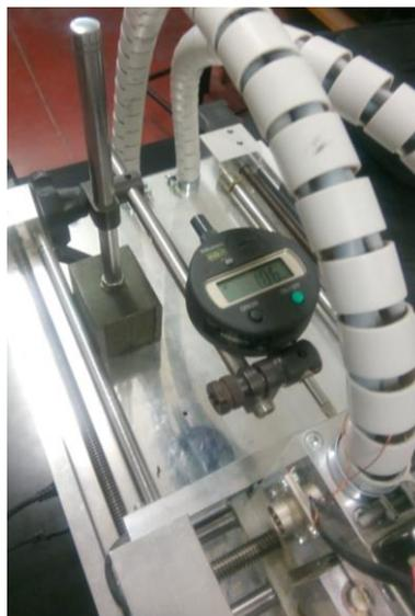
Figura 45 - Avaliação da repetibilidade do equipamento, no eixo do Y, utilizando um comparador (com um valor inicial pré-definido de 1.06mm).
