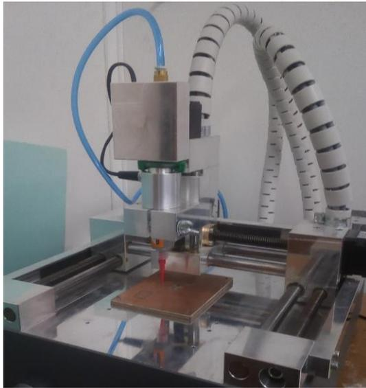
Figura 53 - Acessório de deposição de pasta de solda acoplado na máquina.
