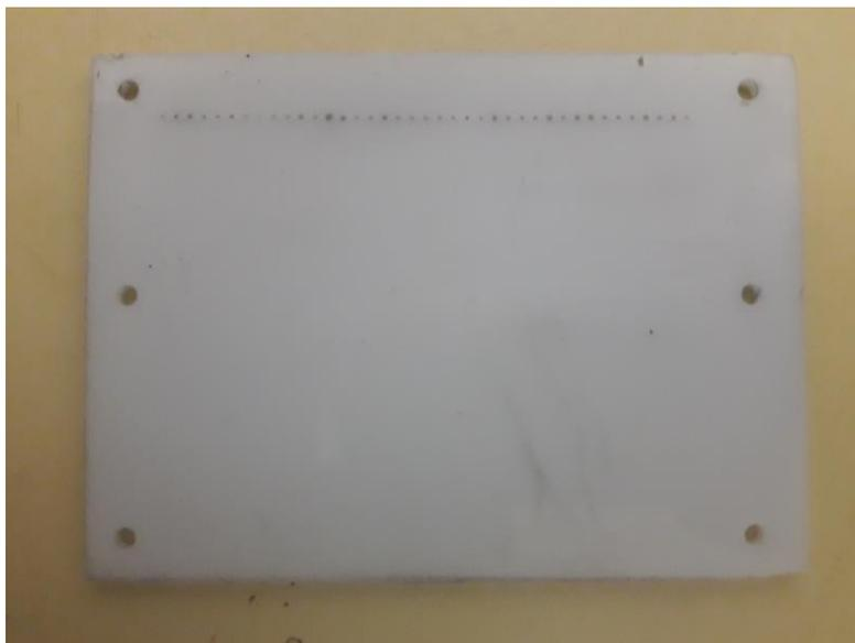
Figura 94 - Tabuleiro perfurado para a colocação de filamentos
