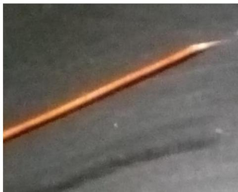
Figura 95 - Filamento com a extremidade "afiada" com um ângulo de aproximadamente de 45°.
