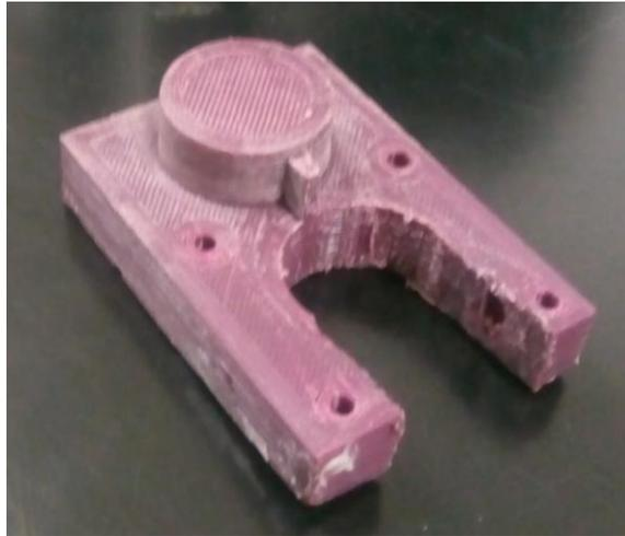
Figura 93 - Acessório impresso em PLA para acomodar o motor de passo.
