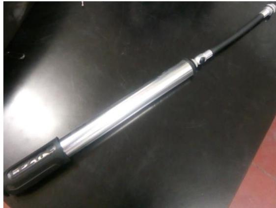
Figura 54 - Bomba pneumática, utilizada na pressurização do ar para o reservatório do equipamento.
