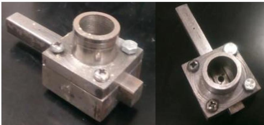
Figura 87 - Parte responsável pelo corte do fio, fabricada toda ela em aço (representada em duas vistas diferentes).
