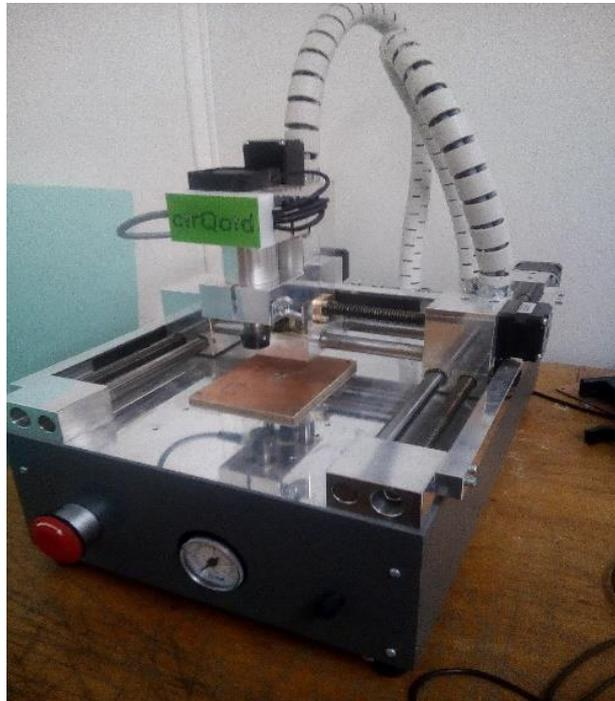
Figura 40 - Máquina de prototipagem de PCB, denominada *Cirquid*.
