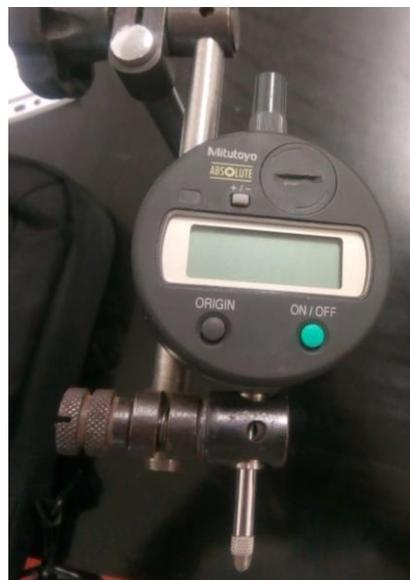
Figura 47 - Comparador utilizado no teste de repetibilidade
