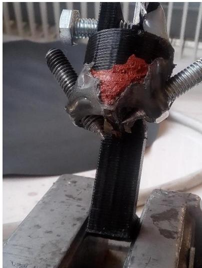
Figura 79 - Dispositivo desenvolvido para testar o corte do fio através de um curto circuito.
