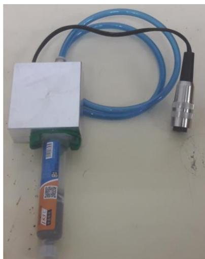
Figura 52 - Acessório para deposição de pasta de solda.
