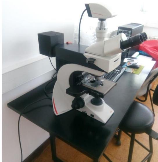
Figura 50 - Microscópio ótico *Leica DM 2500 M*.
