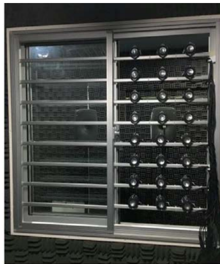
Figura 2.35. Controlo ativo de ruído em janela de correr aberta (adaptado de Lam et al., 2020).
