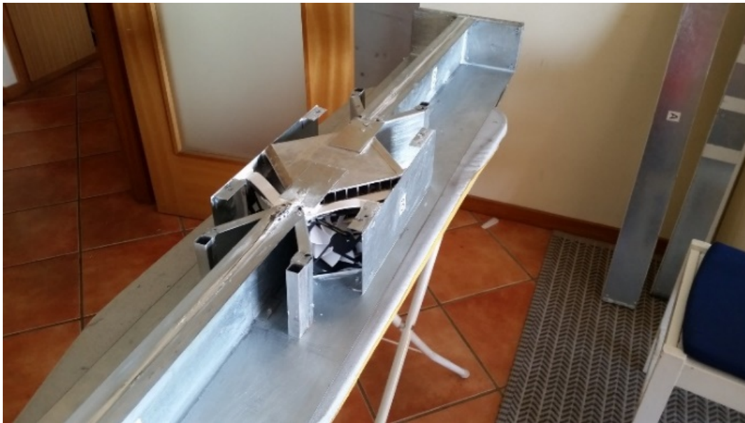
Figura 3.22. Instalação da ventoinha e conversor de energia elétrica para 12 V.
