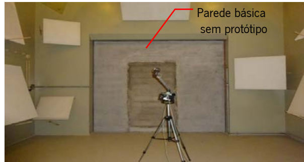
Figura 3.25. Teste acústico da parede sem protótipo.
