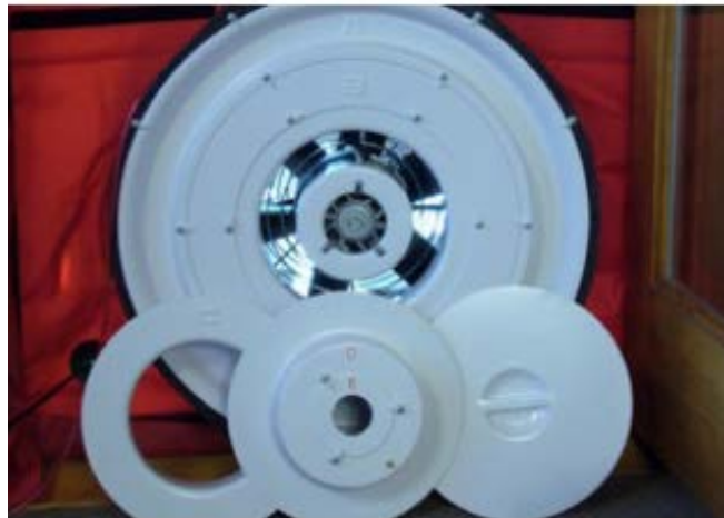
Anéis da porta ventiladora.
