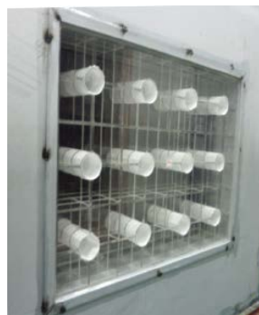
Figura 2.24. Metamateriais acústicos em janela naturalmente ventilada (adaptado de Kim e Lee (2014)).
