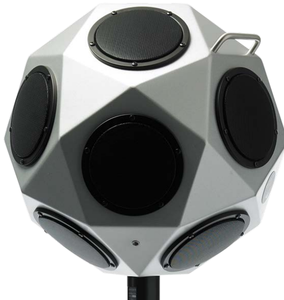
Fonte sonora omnidirecional dodecaédrica B & K Modelo 4292.
