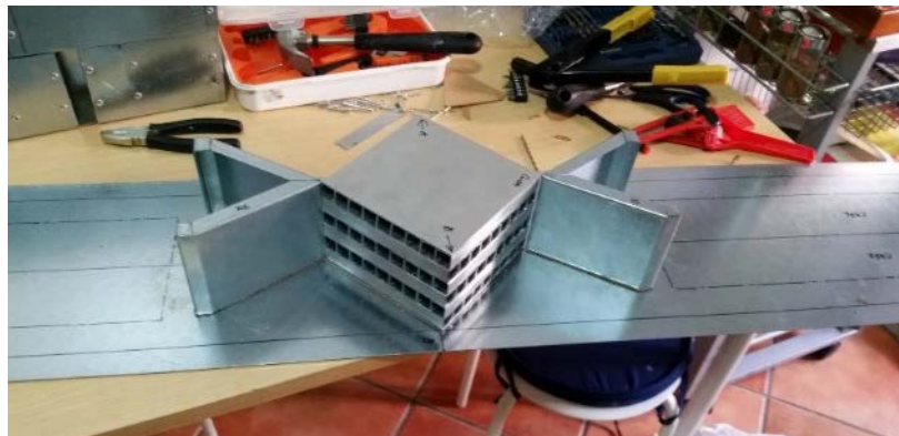
Figura 3.16. Montagem das aletas defletoras.
