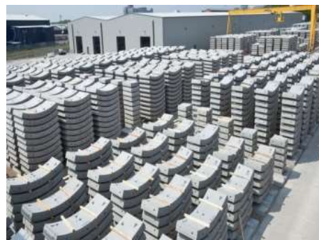
Fig.376-Zona de execução de aduelas [236]
