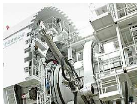
Fig.256-Zona de montagem de pregagens [319]
