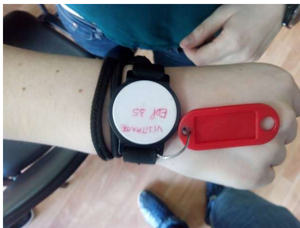
Fig.69-Sistema de controlo eletrónico de acessos [277]
