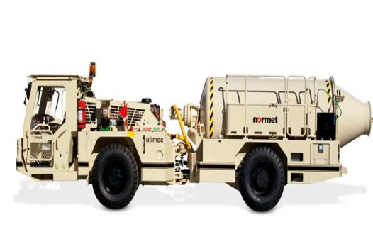
Fig.334-Equipamento para transporte de betão [206]
