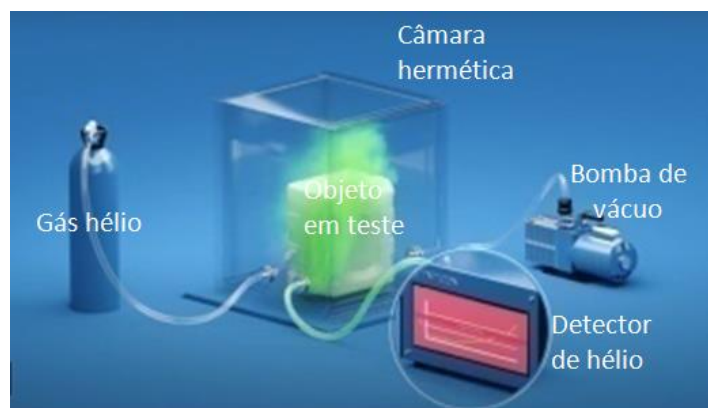
Figura 6 – Esquema de teste utilizando camara de He – Adaptado de Inficon, (2019a)
